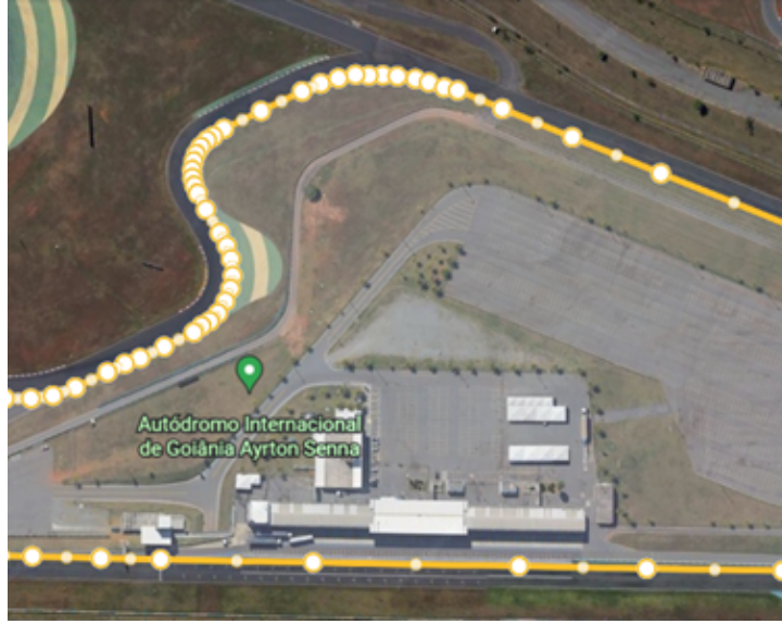
Figura 3.3: Pontos GPS coletados para virtualização do limite interno da pista de Goiânia
