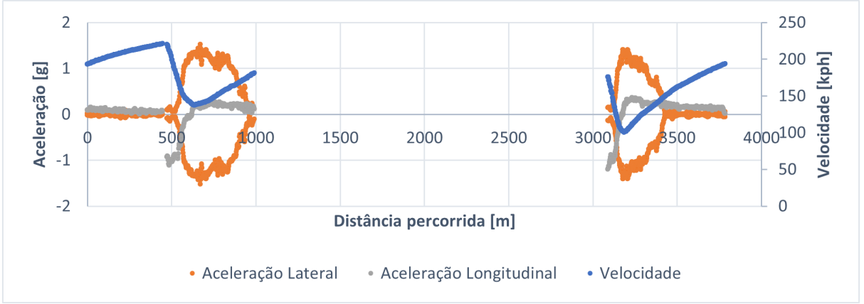
Figura 4.19: Dados para a construção do modelo super-elíptico: velocidade, acelerações lateral e longitudinal nos trechos de máxima performance.
