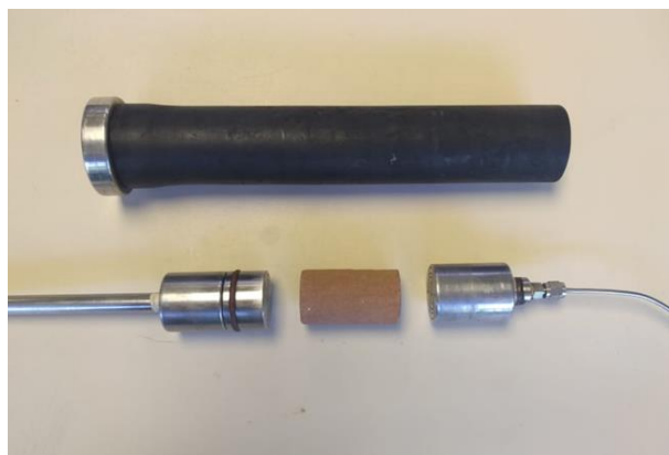
Figura 23 – Componentes utilizados no processo de confinamento do plug no interior do core holder .
