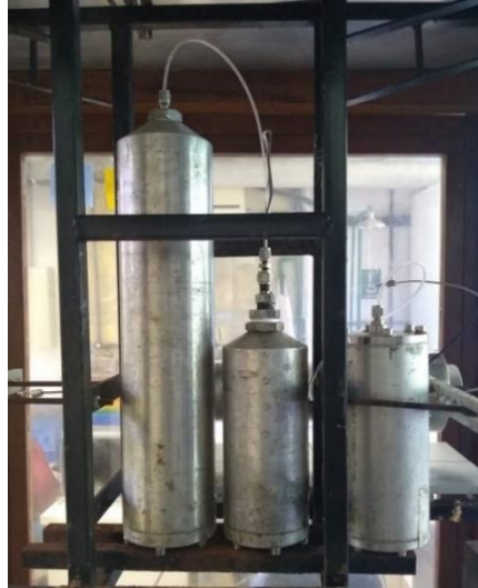
Figura 21 – Silos utilizados para armazenar os fluidos de injeção.
