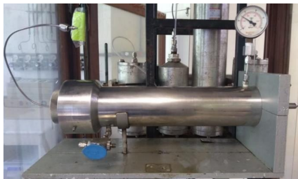
Figura 19 – Vista lateral do core holder utilizado nos testes de injeção.
