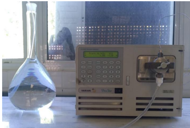
Figura 22 – Bomba de HPLC utilizada nos testes de injeção.
