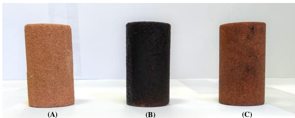
Figura 37 – Diferença entre um plug limpo e seco (A), um plug saturado com óleo (B) e o plug 4, após a recuperação não convencional utilizando o fluido de injeção Bio-ASP8 (C).
