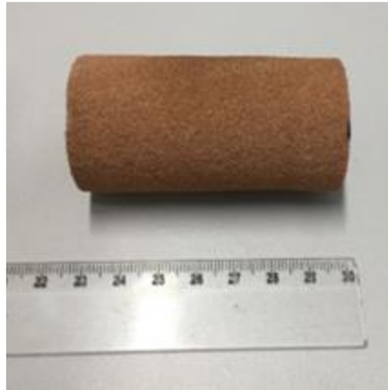
Figura 15 - Plug utilizado nos testes de injeção
