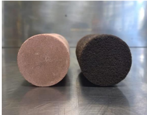
Figura 16 – Vista da seção transversal de um plug antes do teste de injeção (esquerda) e após o processo de saturação com óleo (direita).
