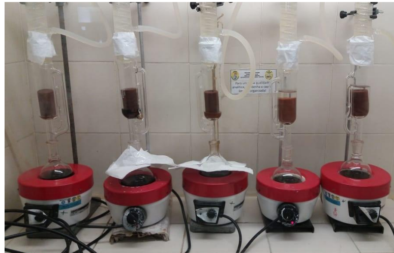
Figura 17 – Utilização do sistema soxhlet em série, para a limpeza dos plugs utilizados nos testes de injeção.
