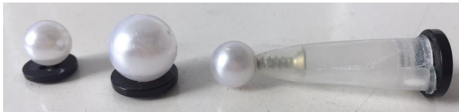
Figura 1 – Marcadores DIPA ® : da esquerda para a direita, bola pequena (BP) fixada na base de plástico, bola média (BM) fixada na base de plástico e Haste (composta pela bola pequena, tampa de caneta e base de plástico).
