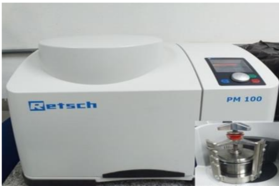
Figura 12 – Moinho de bolas para reduzir a granulometria das amostras
