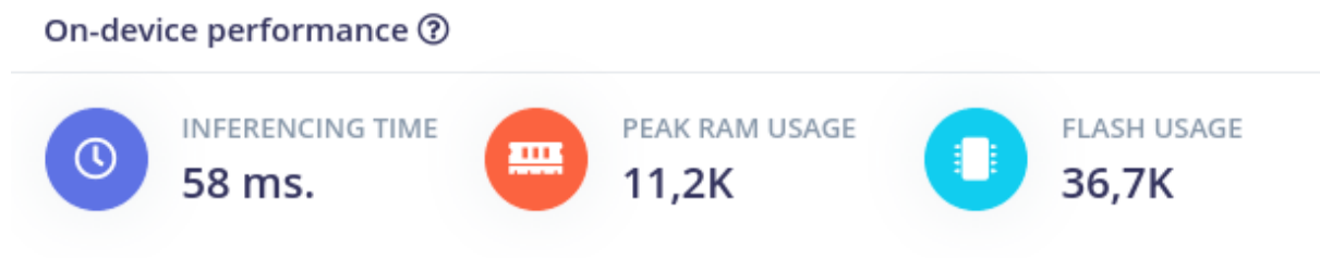
Fig. 19 – Estimativa de Desempenho no Arduino Nano 33 BLE Sense
