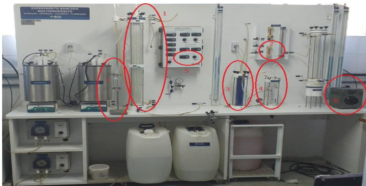
Figura 18-- Bancada-- Coluna de absorção contínua: líquido-gás – leito fixo com recheio (1), rotâmetro (2), coluna de adsorção com sílica (3), saturador de ar (4), painel do leitor de temperatura (5), transformador de voltagem (6), borbulhador (7) Fonte : Próprio autor
