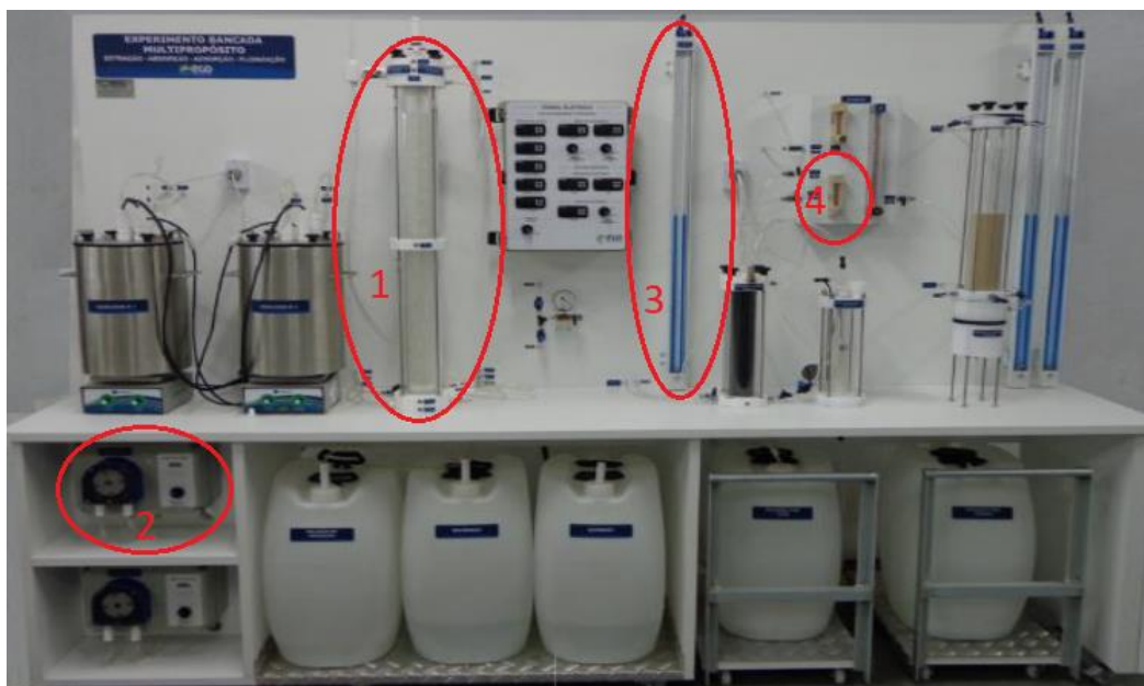
Figura 15- Bancada multiprósito – Coluna de absorção contínua: líquido-gás – leito fixo com recheio (1), bomba peristáltica (2), manômetro tubo em U (3), rotâmetro (4). Fonte : Próprio autor
