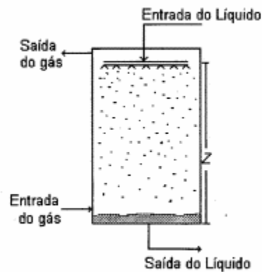
Figura 2– Coluna ilustrativa tipo “spray”(Fonte: REVELLO,1998)
