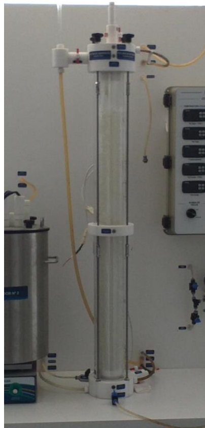
Figura 14 Coluna de absorção recheada com anéis de Raschig - Fonte : Próprio autor
