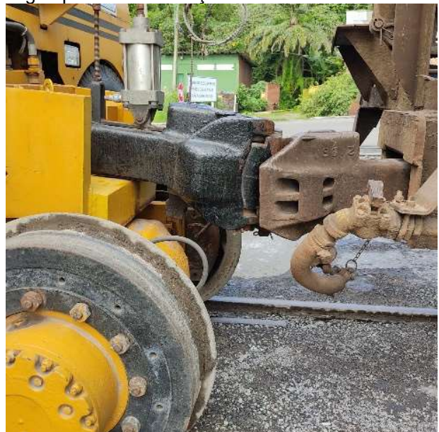
Figura 24b – Detalhe do engate do locotrator no vagão para movimentação
