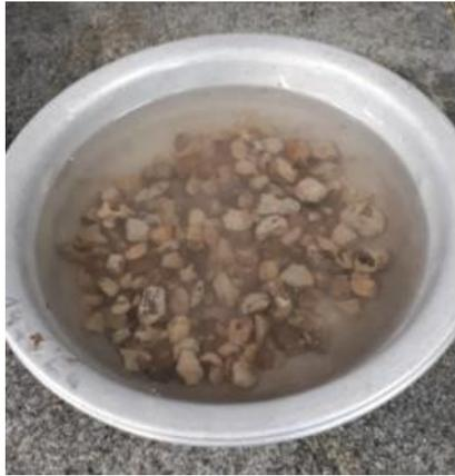
Figura 30 – Retirada da argamassa.
