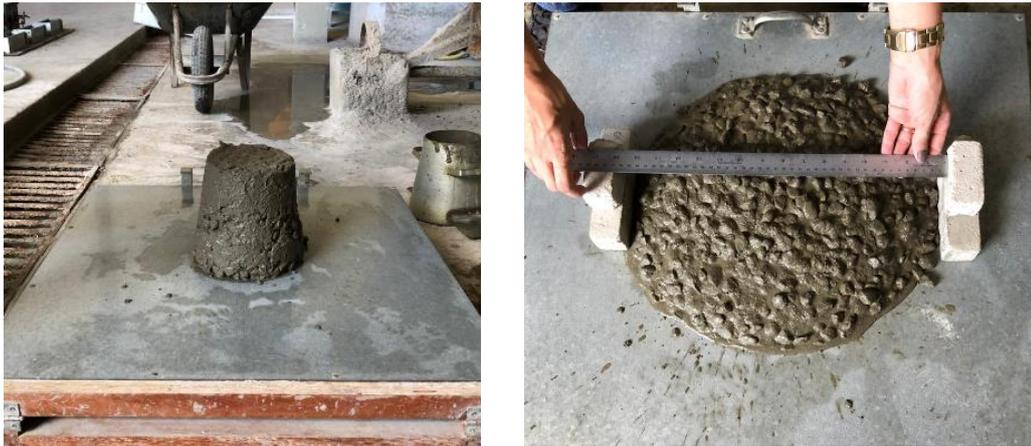
(A) Mistura após a retirada do molde. (B) Medidas do espalhamento.
