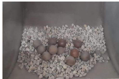
(B) Esferas juntamente com amostra.
