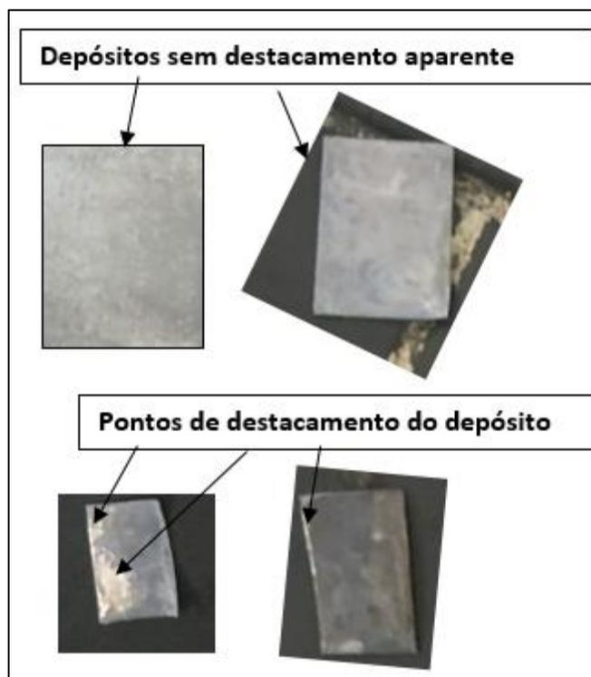
Figura 15. Imagens dos depósitos após teste de aderência (Fonte: Próprio autor, 2021)
