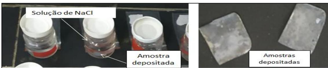
Figura 14 - Ensaio de perda de massa (Fonte: Próprio autor, 2021)
