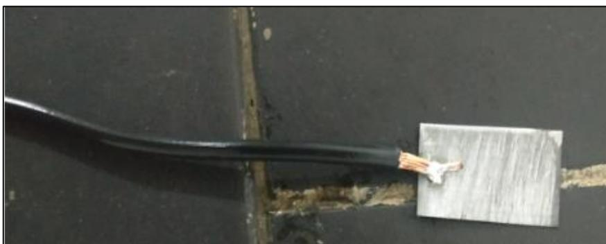
Figura 10 - Construção do eletrodo de trabalho (Fonte: PRÓPRIO AUTOR, 2022)
