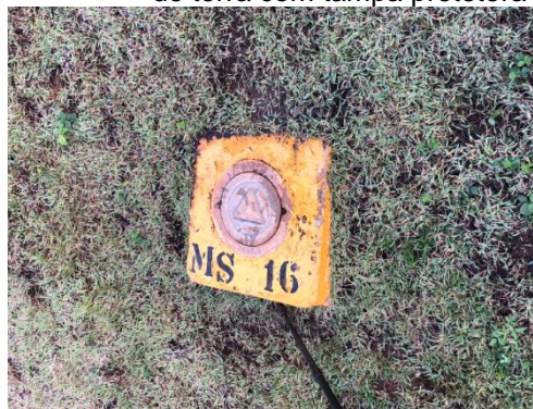
FIGURA 10 – MS instalado em barragem de terra com tampa protetora
