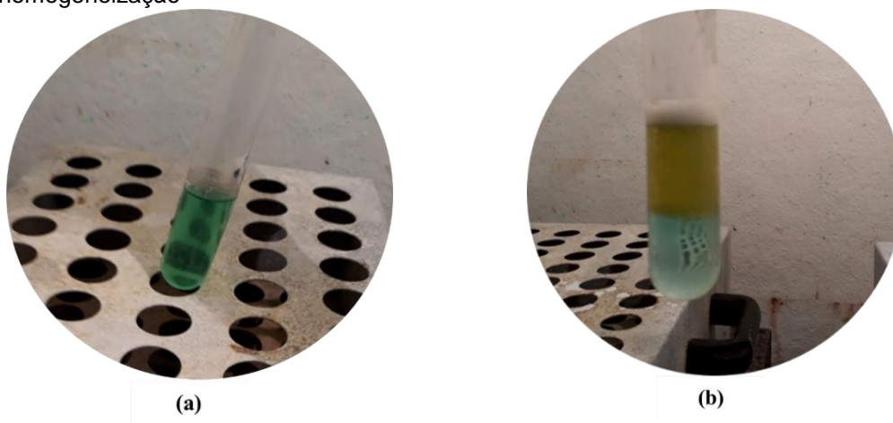
Figura 23- Teste do procedimento de preparo das amostras de fezes bovina, contendo dióxido de titânio, (a) ao fim do processo de digestão e (b) logo após adição de \text{H}_2\text{O}_2 , sem homogeneização
