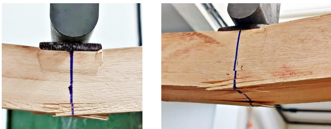
Figura 50 – Ruptura dos corpos de prova obtidas no ensaio de cisalhamento.
