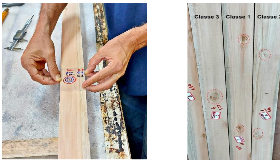
Figura 31 – Gabarito e lamelas classificadas.
