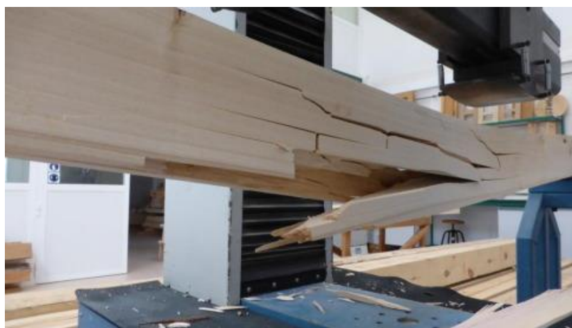
Figura 13 -Falha de uma viga sem reforço.
