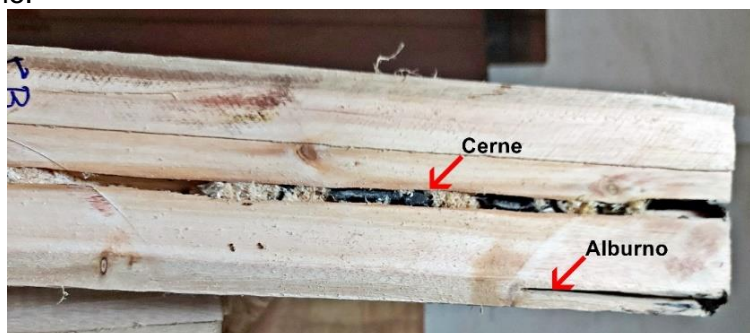
Figura 53 – Ataque de térmita de solo ao Clone Eucalyptus urophylla COP 1404 na região do cerne e alburno.
