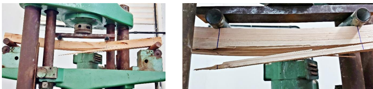
Figura 51 – Ruptura à flexão de 4 pontos.
