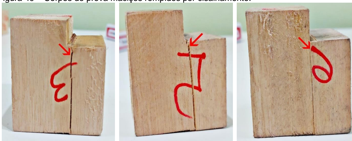
Figura 49 – Corpos de prova maciços rompidos por cisalhamento.
