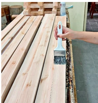
Figura 35 – Processo de colagem de lamelas sem fibra de carbono (LSFC)
