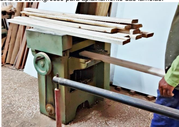
Figura 34 – Máquina de desengrosso para aplainamento das lamelas.
