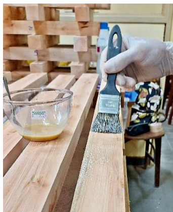
Figura 35 – Processo de colagem de lamelas sem fibra de carbono (LSFC)
