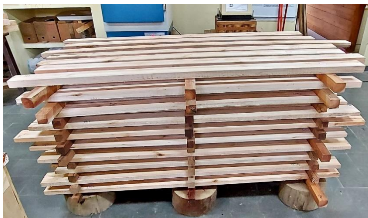
Figura 25 – Disposição das lamelas entablicadas para secagem ao ar.
