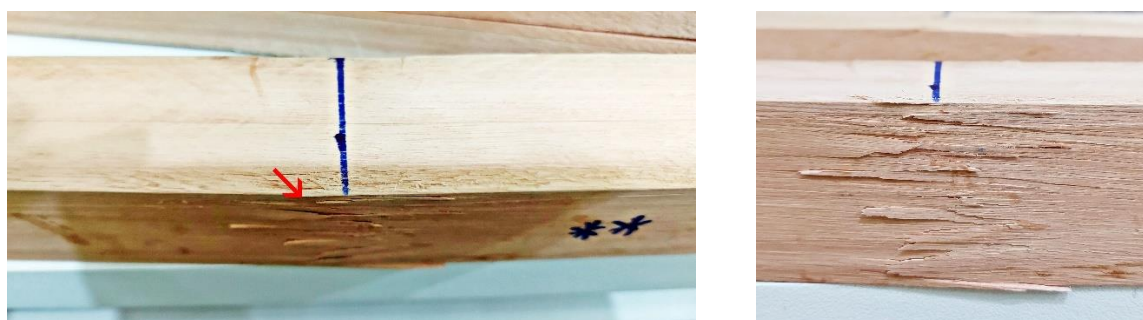
Figura 56 – Ruptura típica ao cisalhamento paralelo dos corpos de prova LSFC.
