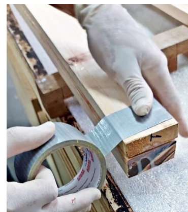
Figura 35 – Processo de colagem de lamelas sem fibra de carbono (LSFC)
