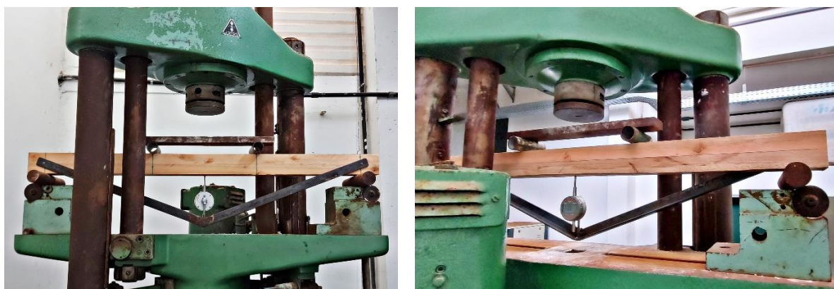
Figura 27 – Configuração do ensaio de flexão de 4 pontos.
