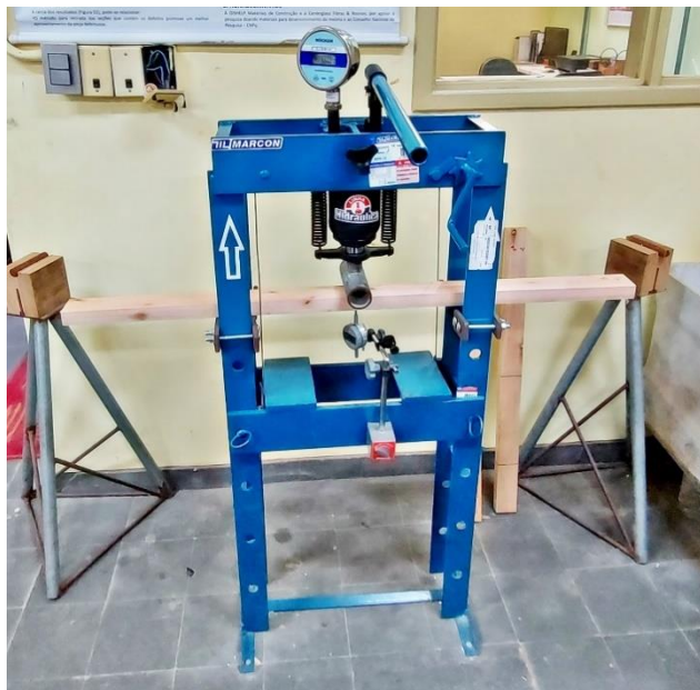
Figura 33 – Ensaio de flexão a três pontos para classificação mecânica.
