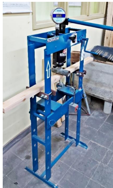
Figura 33 – Ensaio de flexão a três pontos para classificação mecânica.
