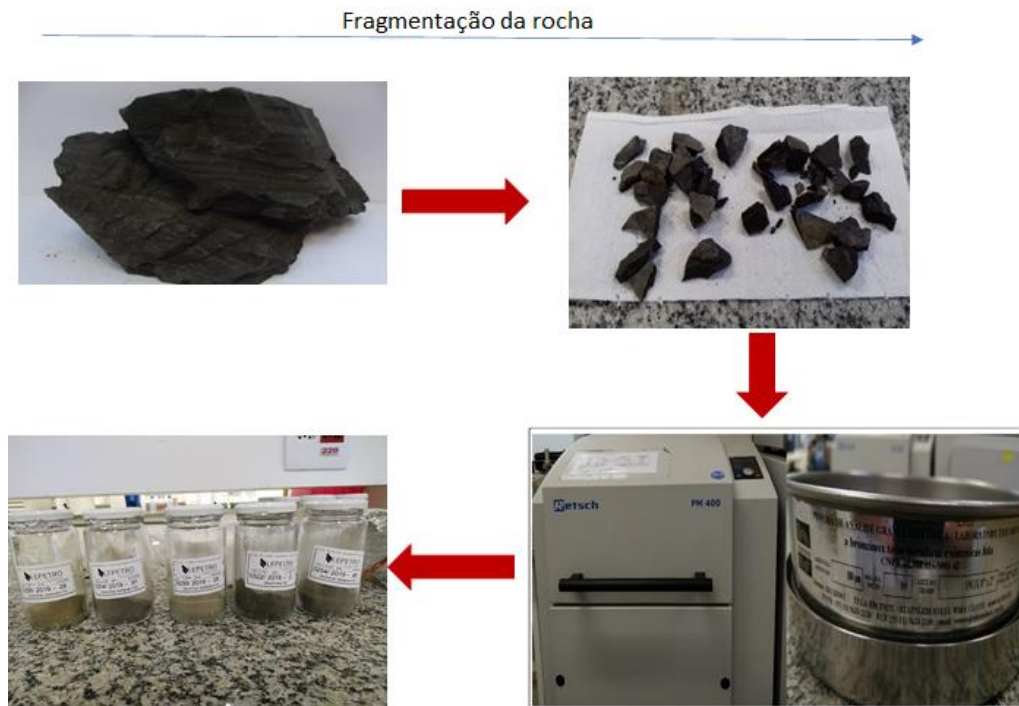
Figura 5- Esquema de preparo de amostras da Formação Pojuca, Bacia do Recôncavo
