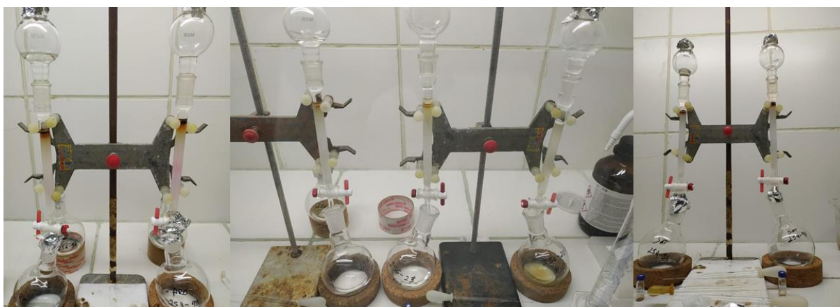
Figura 8 – Amostras da Formação Pojuca representando o fracionamento e obtenção das três principais frações
