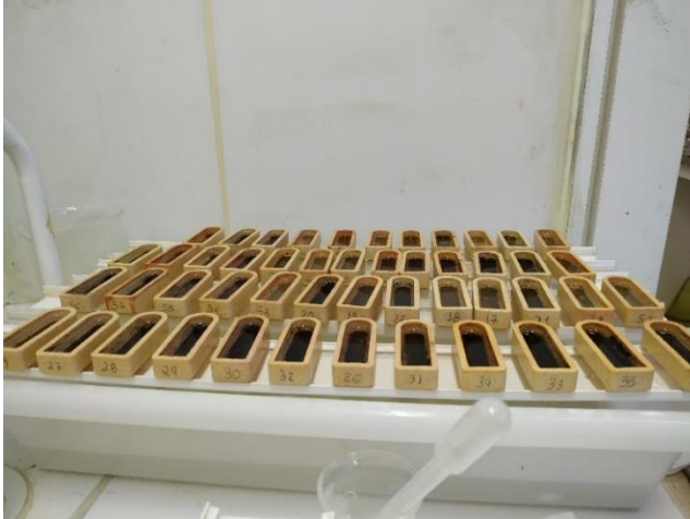
Figura 6- Alíquotas com 1g de amostras da Formação Pojuca pulverizadas para acidificação e posterior quantificação do RI e análises dos isótopos estáveis de carbono orgânico.
