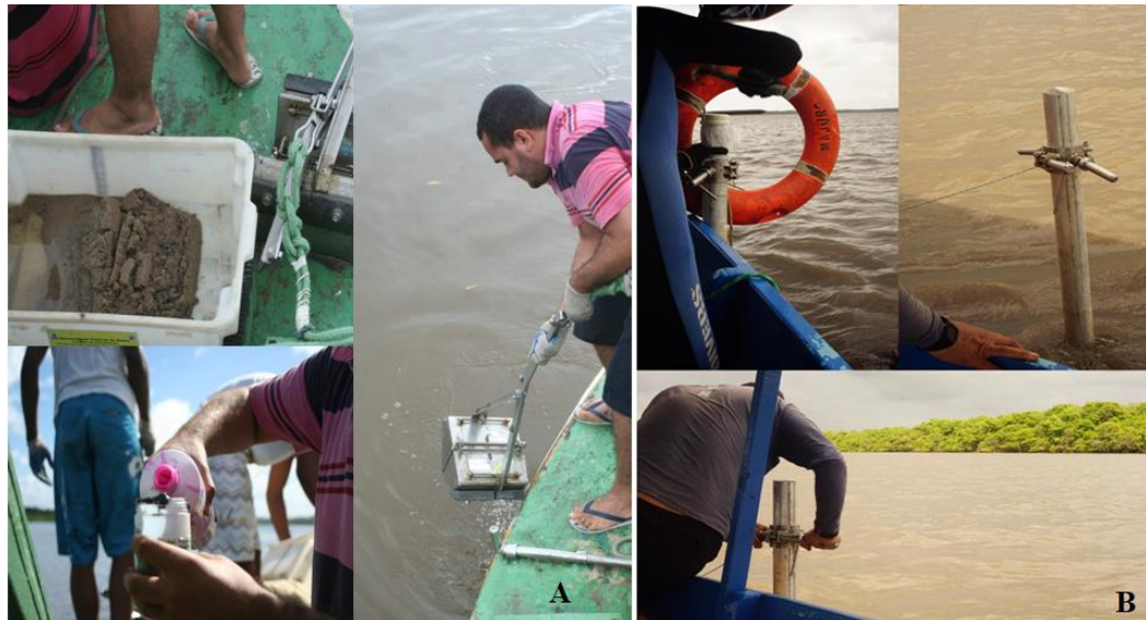
Figura 1. Procedimento amostral para coleta de sedimento de fundo através da draga van Veen (A) e amostras de subsuperfície com auxílio de testemunhos rasos de sondagem (B) no canal estuarino do Real
