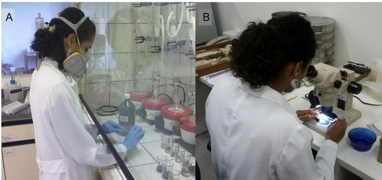
Figura 6. Flotação das testas de foraminíferos (A) e triagem e identificação dos foraminíferos (B) com auxílio de uma lupa estereomicroscópio das amostras do canal estuário do Real
