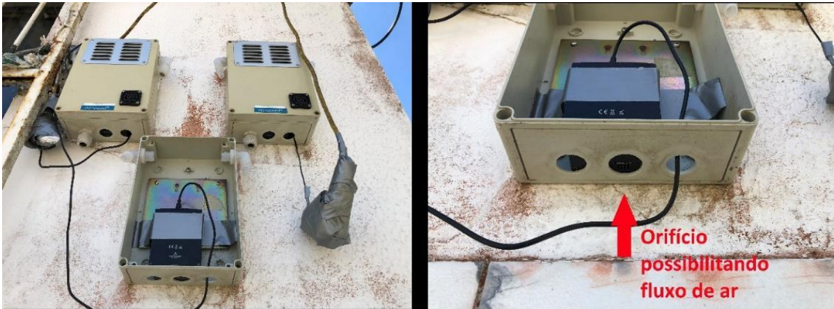
Figura 8: Adaptação das caixas do monitor AEROQUAL SERIES 500 para uRADMonitor, modelo A3.
