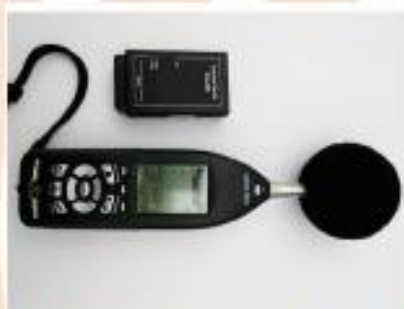
Foto 01 – Sonômetro e calibrador Larson Davis. Fonte: Acervo Audium.
