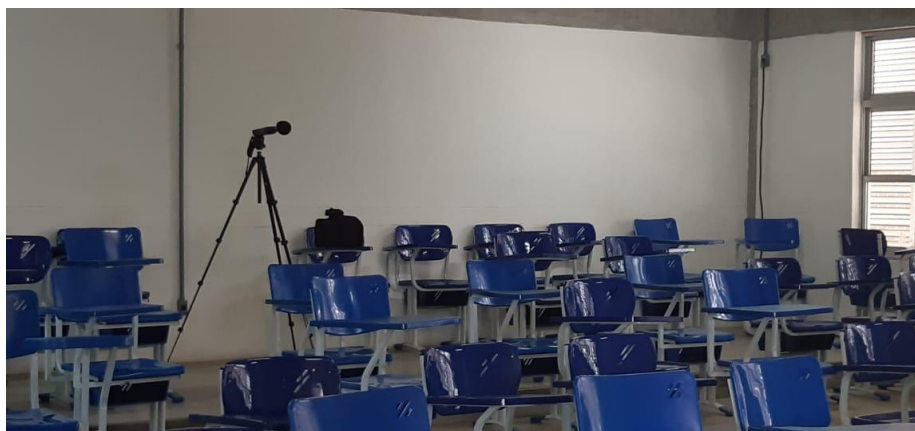
Fotografia 9. Medidor integrador de pressão sonora posicionado
