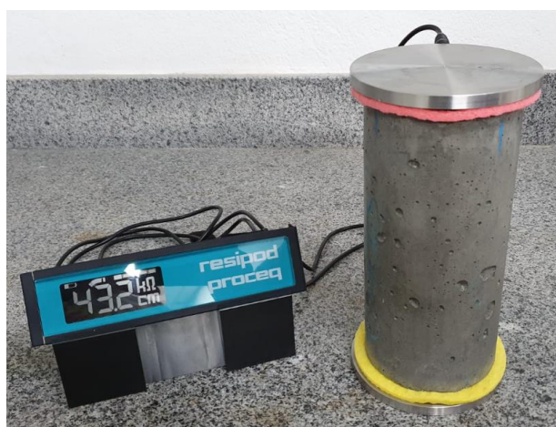
Figura 3.13. Execução do ensaio de resistividade elétrica volumétrica.
