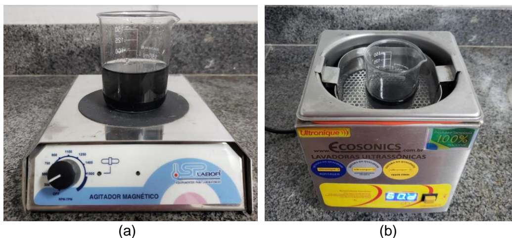
Figura 3.2. Amostra de NTC em (a) agitador magnético e (b) banho ultrassônico.
