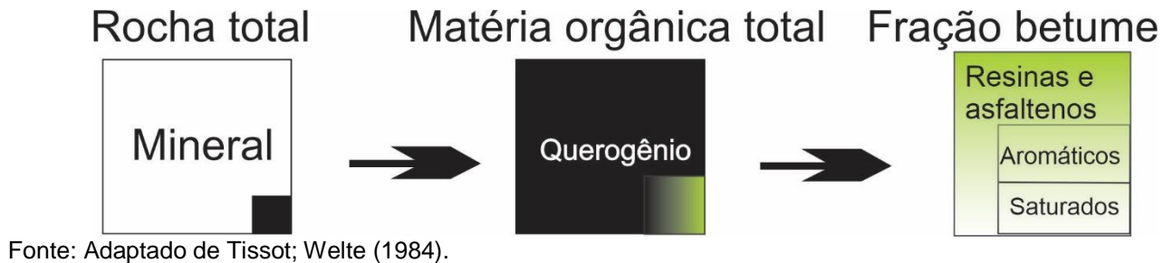
Figura A.6 - Composição geoquímica das rochas geradoras de petróleo
