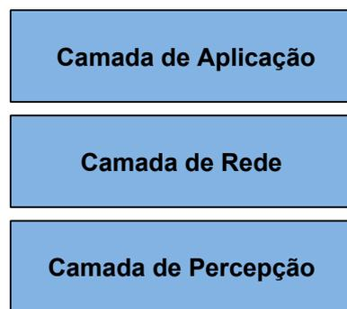
**Figura 2.1** Arquitetura IoT em três camadas (WU et al., 2010).
