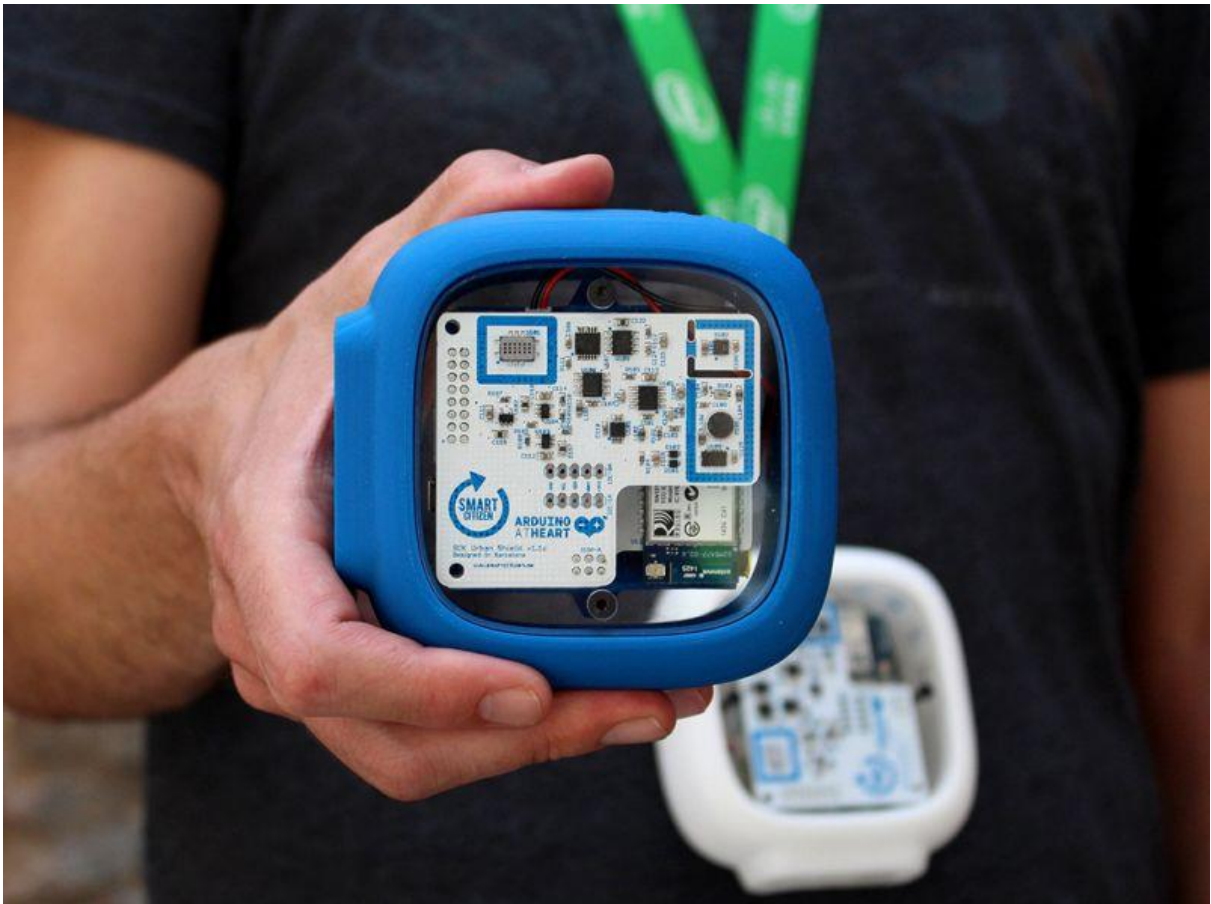
Figura 5 – Smart Citizen Kit contendo sensores e microprocessadores
