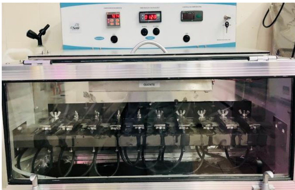
Figura 4 - Escovação simulada com solução de dentifrício contendo carvão ativado em máquina de escovação.
