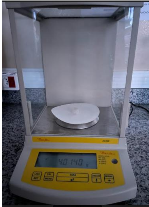
Figura 5 - Pesagem do corpo de prova em balança de precisão para avaliação da massa.
