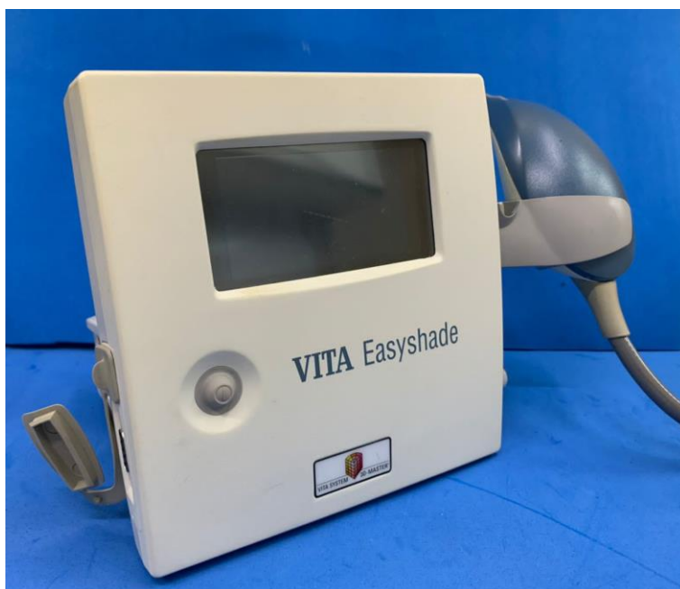
Figura 7 - Espectrofotômetro Easyshade – Vita® utilizado para avaliação da cor.
