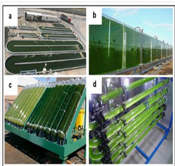
Figura 6: Sistemas utilizados no cultivo de microalgas (a) lagoa aberta, (b) placa plana, (c) tubular inclinado, (d) horizontal contínuo
