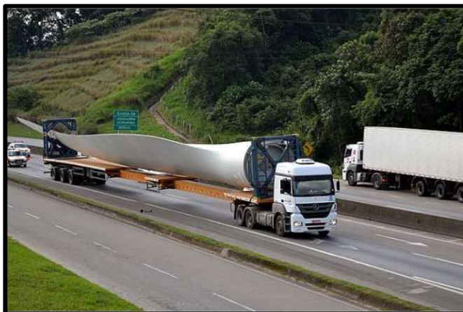
Figura 17 - Transporte Rodoviário de uma Pá Eólica
