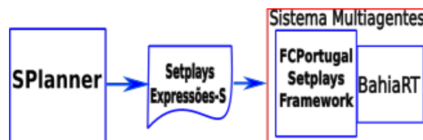
Figura 4.15: SPlanner gera um arquivo de expressões-S contendo um setplay para ser interpretado pelo FSF e executado pelo BahiaRT.
