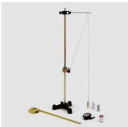
Figura 2 – Kit experimental de Pêndulo Simples
