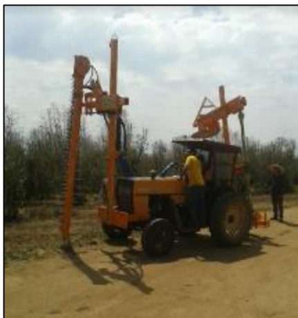
Figura D11. Máquina de podar café
