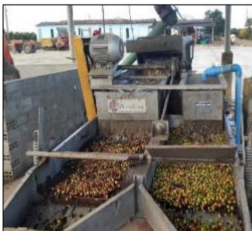
Figura D13. Lavador/Separador de Café
