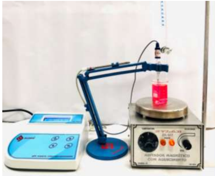
Figura 2 – Determinação da acidez total titulável das formulações farmacêuticas com utilização de pHmetro microprocessado e agitador magnético.
