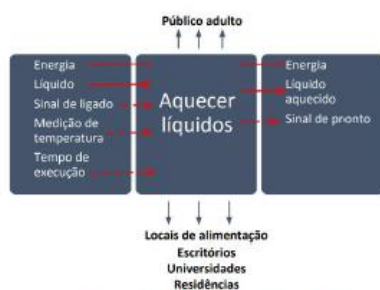
Figura 10 – Estrutura funcional do produto. Fonte: Própria
