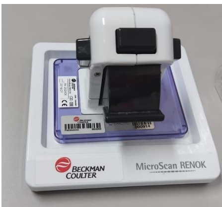
Figura 10 – Inoculador de painéis RENOK
