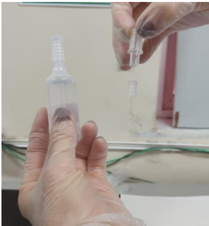
Figura 9 – Agulha do PROMPT e frasco com 30mL de água Pluronic-D estabilizado
