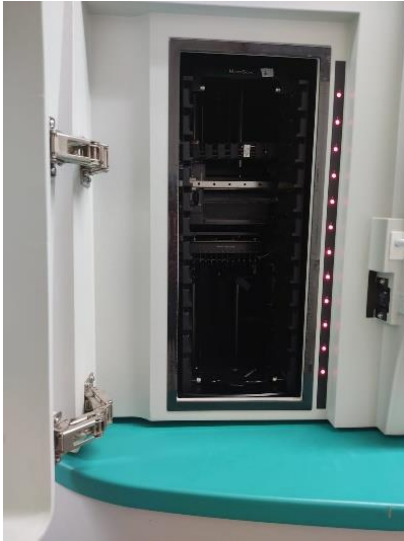
Figura 11 – Local onde os painéis são incubados a 35°C no equipamento
