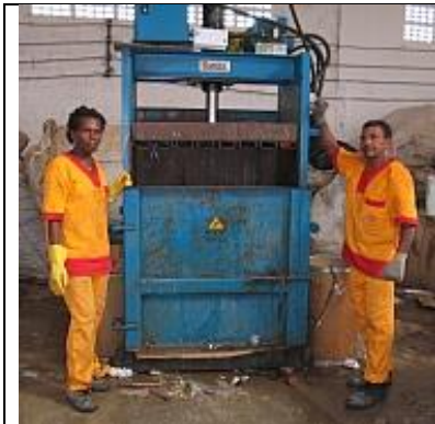
Figura: Prensa para embalagem de papel e plástico para o envio às indústrias, 2010.
