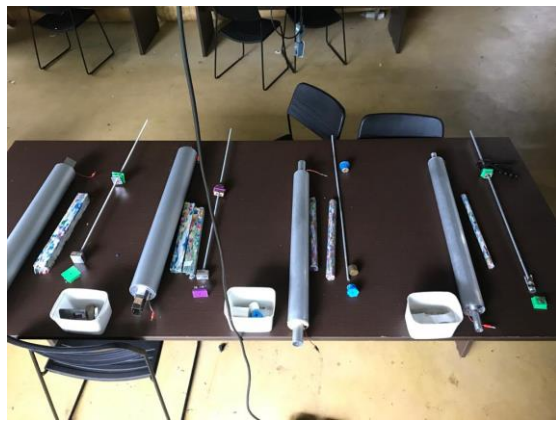
Figura 28 - Moldes/shapes em forma de cilindro para a fabricação das barras de plástico.
