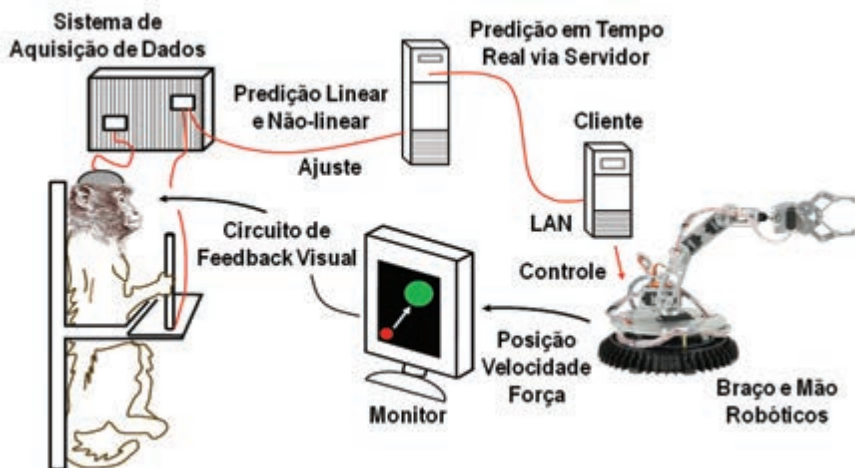
Figura 42 – Diagrama esquemático do experimento do Prof. Nicoletis e colaboradores sobre o controle da mente por uma máquina
