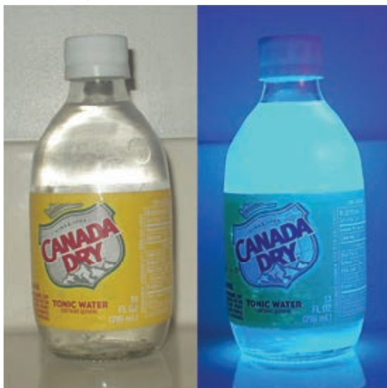
Figura 65 - Uma garrafa de água tônica sob luz normal, e a mesma quando iluminada por luz ultravioleta (UV), emitindo um brilho característico devido à substância quinina ( C_{20}H_{24}N_2O_2 ) 8
