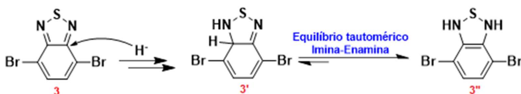
Esquema 12: Mecanismo de redução de 2,1,3-benzotriazol (3)
