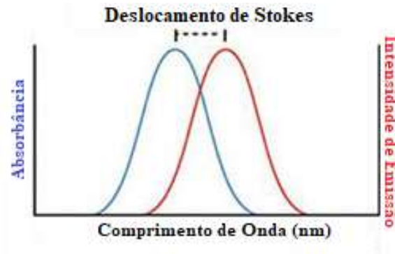
Figura 26: Princípio do deslocamento de Stokes
