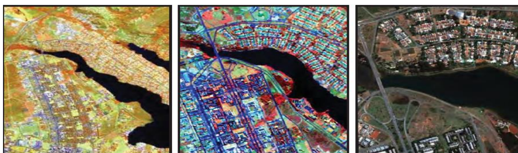
Figura 1. Da esquerda para direita, imagens dos satélites Landsat com resolução espacial de 30, Spot com 10 m e Ikonos com 1 m, de uma porção do lago Paranoá de Brasília.
