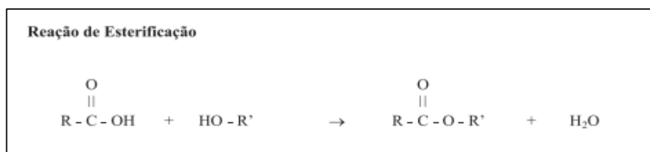
Figura 2.1. Representação esquemática de reação de esterificação.
