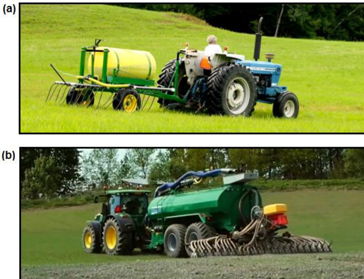
Figura 29 - Aplicação mecanizada da urina em plantações.
