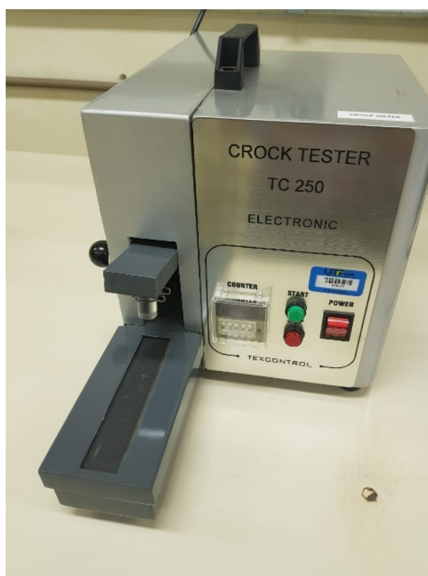
Figura 34 – Equipamento para testes experimentais Crock tester TC 250 da Texcontrol, utilizado para testes de fricção a seco e a úmido nos tecidos tingidos.
