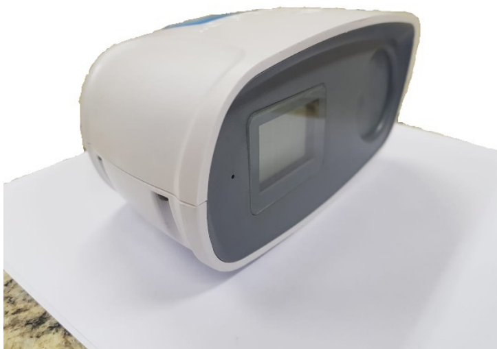
Figura 33 – Espectrofotômetro DeltaVista 450G utilizado para medidas de refletância e do espaço da cor.
