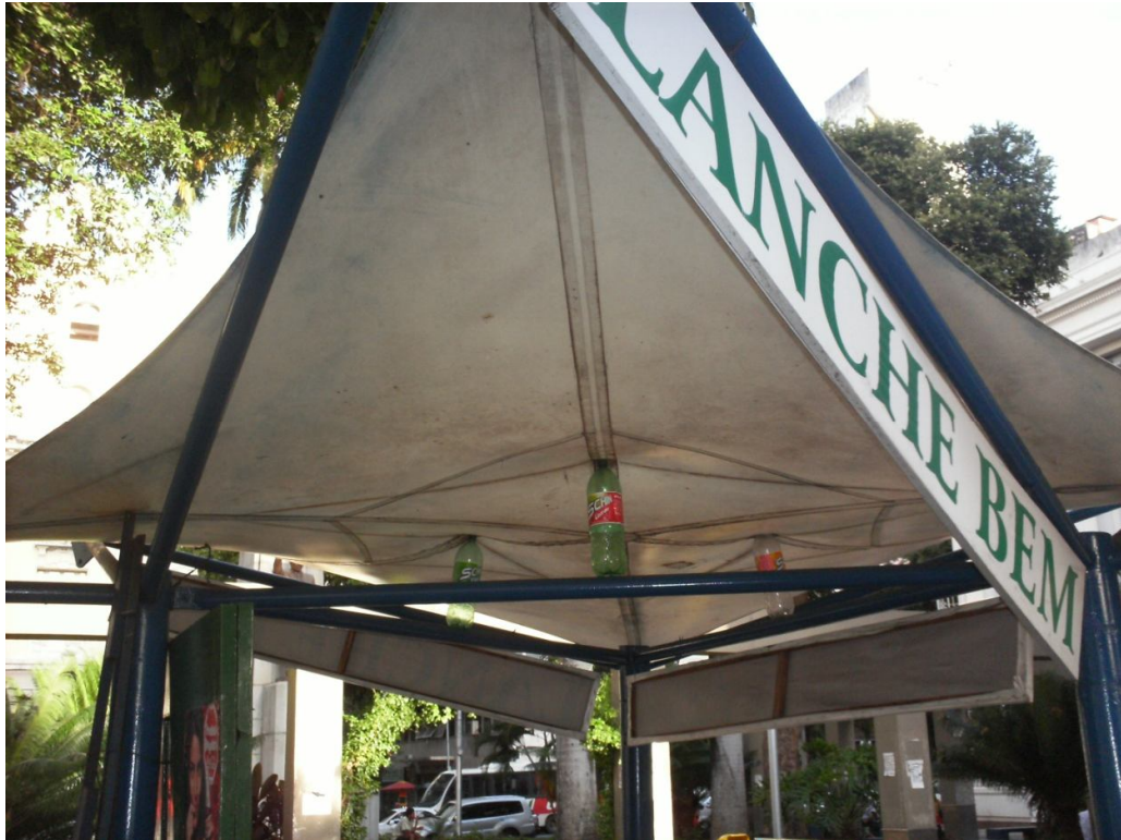
Figura 7 – O imprevisto – a famosa gambiarra – revela um gap sinomórfico óbvio. A elegante lona tensionada, na prática, deixava acumular água. Simples pontaletes de garrafa PET (ou seja, restos baratos) garantem o escoamento. Praça da Inglaterra, Salvador, 2009. Foto do autor.
