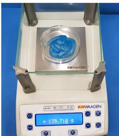
**Figura 5-** Pesagem do dentifrício na balança de precisão para preparo da solução.
