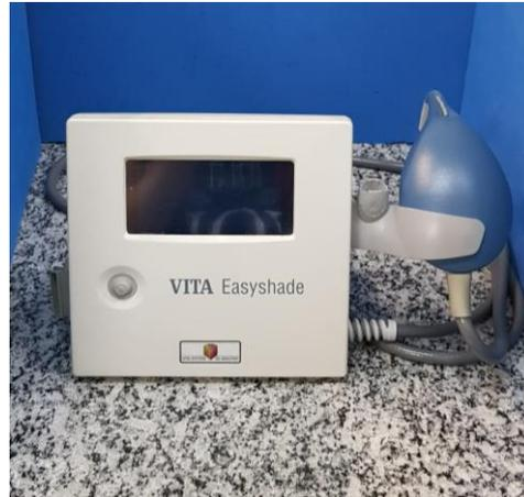
**Figura 11-** Espectrofotômetro Vita easyshade.
