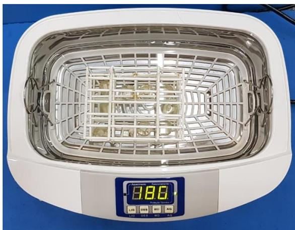
**Figura 7-** Posicionamento e lavagem dos corpos de prova em cuba ultrassônica.
