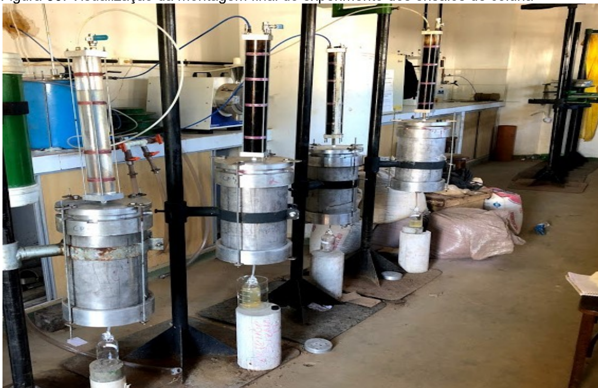
Figura 30. Visualização da montagem final do experimento dos ensaios de coluna
