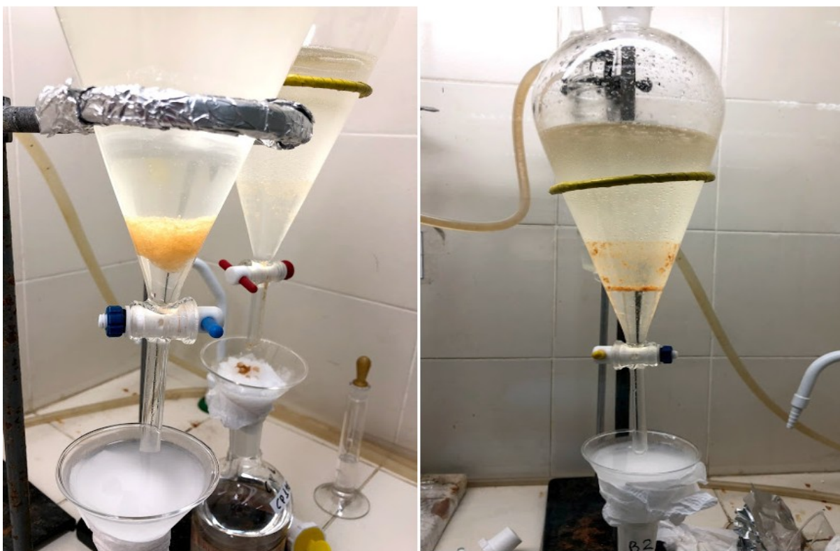
Figura 32. Visualização de parte do processo de obtenção de emulsão formada durante extração de fase oleosa de fluido percolado nas colunas de solo várzea
