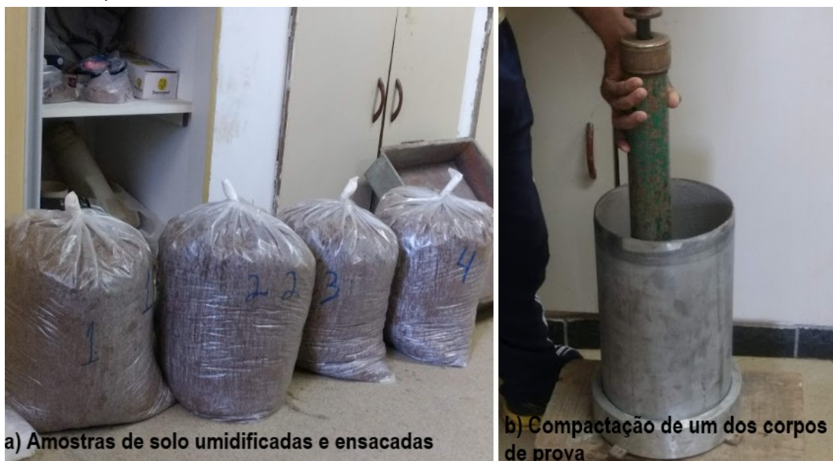
Figura 24. Visualização de parte das etapas de compactação dos corpos de prova realizados para os ensaios de coluna
