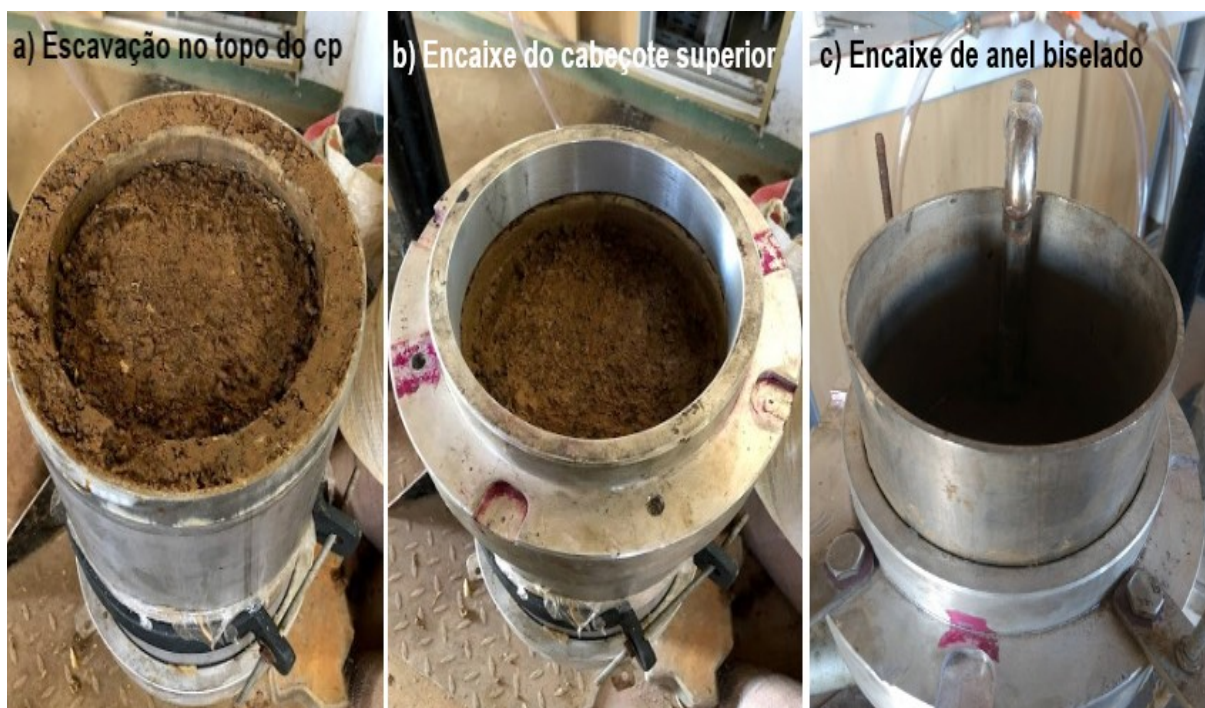
Figura 26. Visualização do encaixe do cabeçote superior e do anel biselado com entrada para a mangueira dos reservatórios
