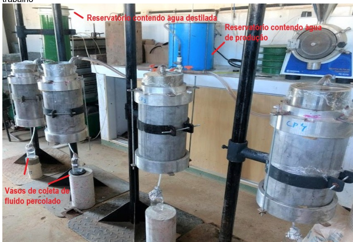
Figura 27. Visualização da montagem inicial dos ensaios de coluna dos experimentos deste trabalho
