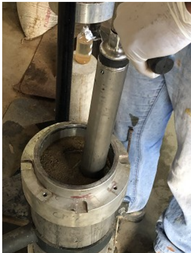
Figura 36. Visualização de parte do procedimento de coleta de amostras das colunas de solo, para análises microbiológicas
