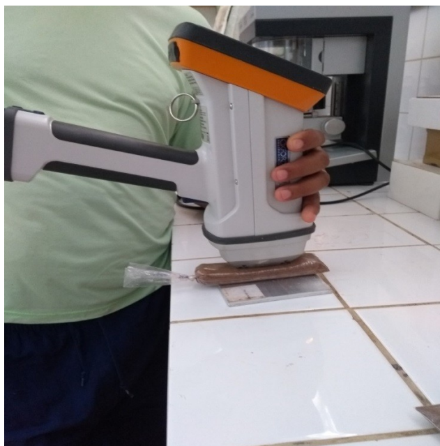
Figura 5. Realização de ensaio de FRX em amostra de solo várzea
