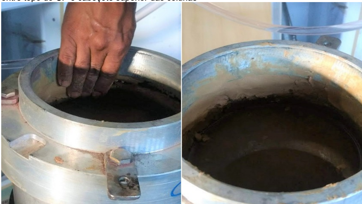
Figura 25. Visualização do processo de aplicação de bentonita para vedação do espaço entre topo do CP e cabeçote superior das colunas
