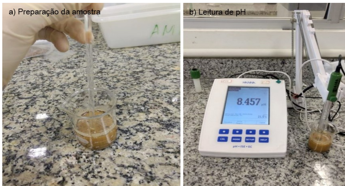
Figura 7. Medição de pH do solo de várzea, realizada no LEPETRO/IGEO/UFBA
