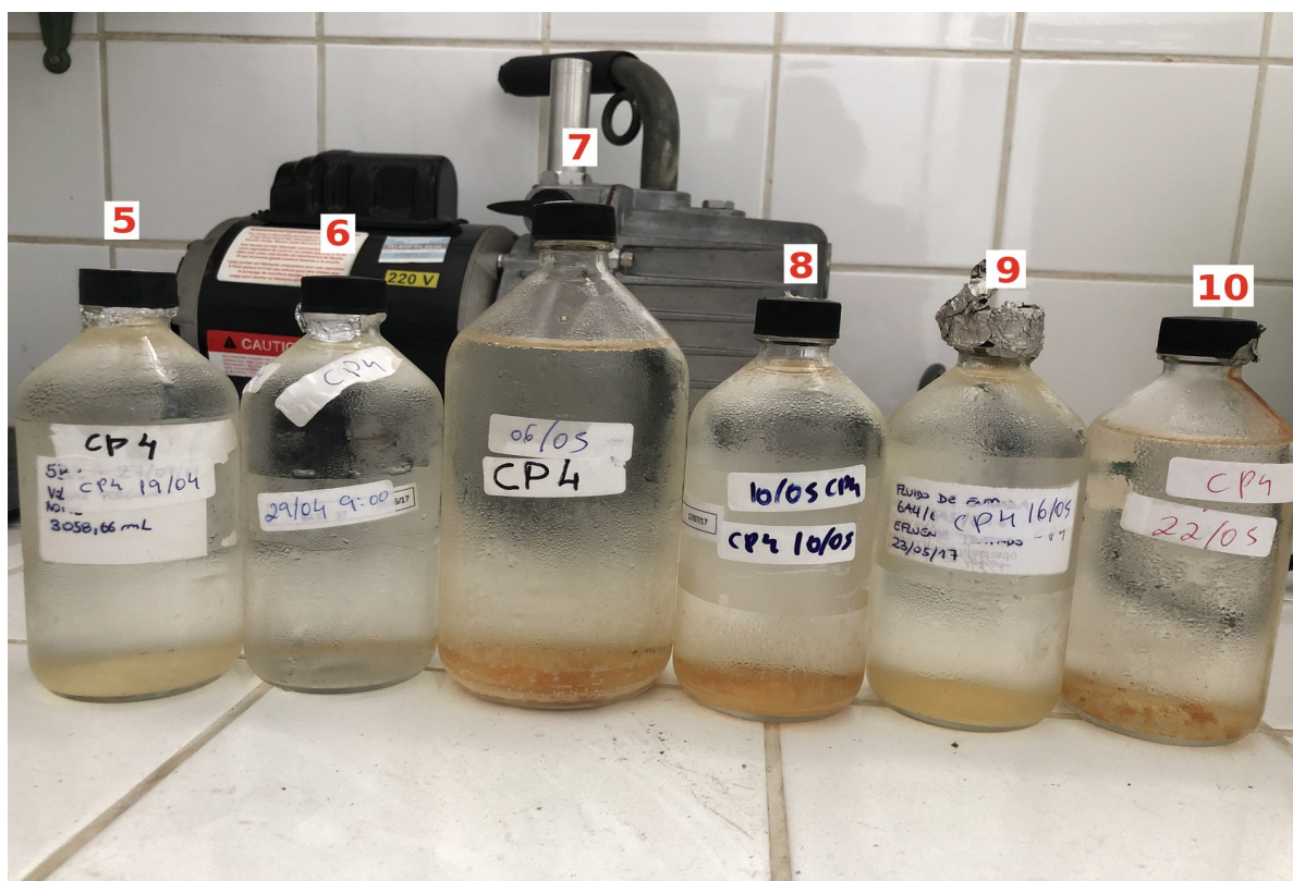
Figura 34. Visualização na mudança de coloração no fluido percolado em coluna de solo várzea
