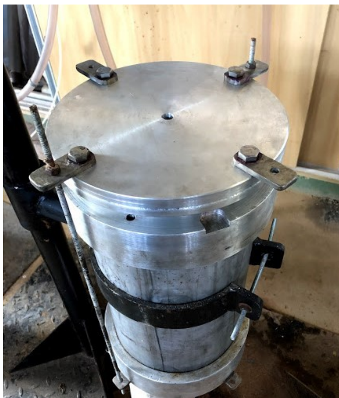
Figura 28. Visualização da tampa metálica encaixada na coluna de percolação de fluido utilizada neste trabalho
