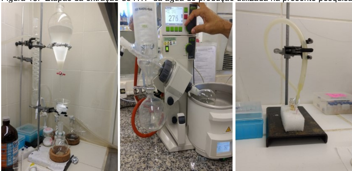
Figura 15. Etapas da extração de HTP da água de produção utilizada na presente pesquisa
