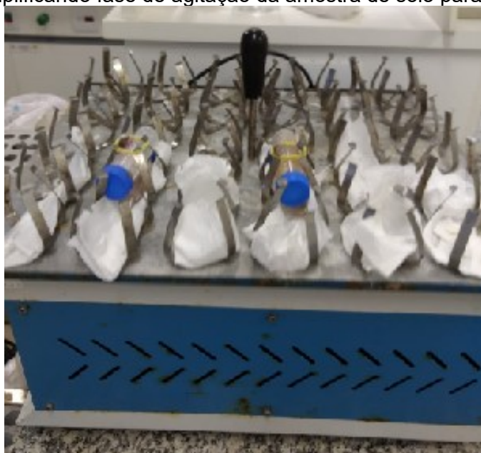
Figura 6. Foto exemplificando fase de agitação da amostra de solo para análise de fósforo
