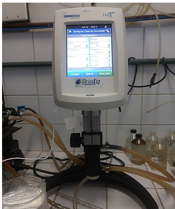
Figura 12. Equipamento viscosímetro utilizado para análises de viscosidade das amostras de água de produção obtidas no GEOAMB/UFBA
