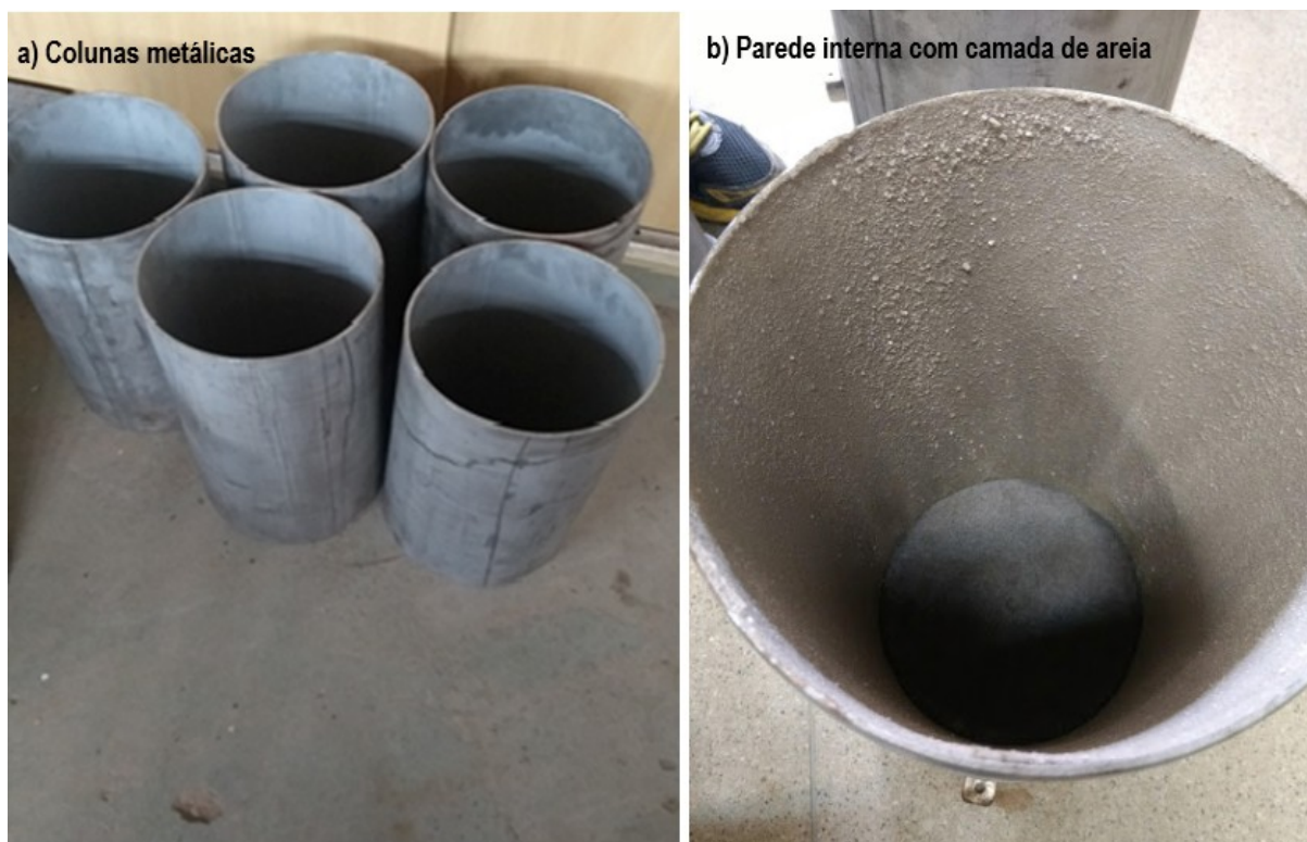
Figura 22. Visualização das colunas metálicas para montagem do ensaio de coluna realizado neste trabalho
