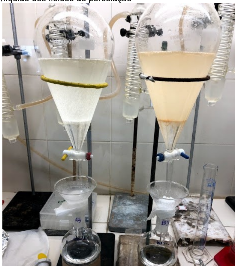
Figura 33. Visualização de emulsões formadas para diferentes corpos de prova durante extração líquido/líquido dos fluidos de percolação
