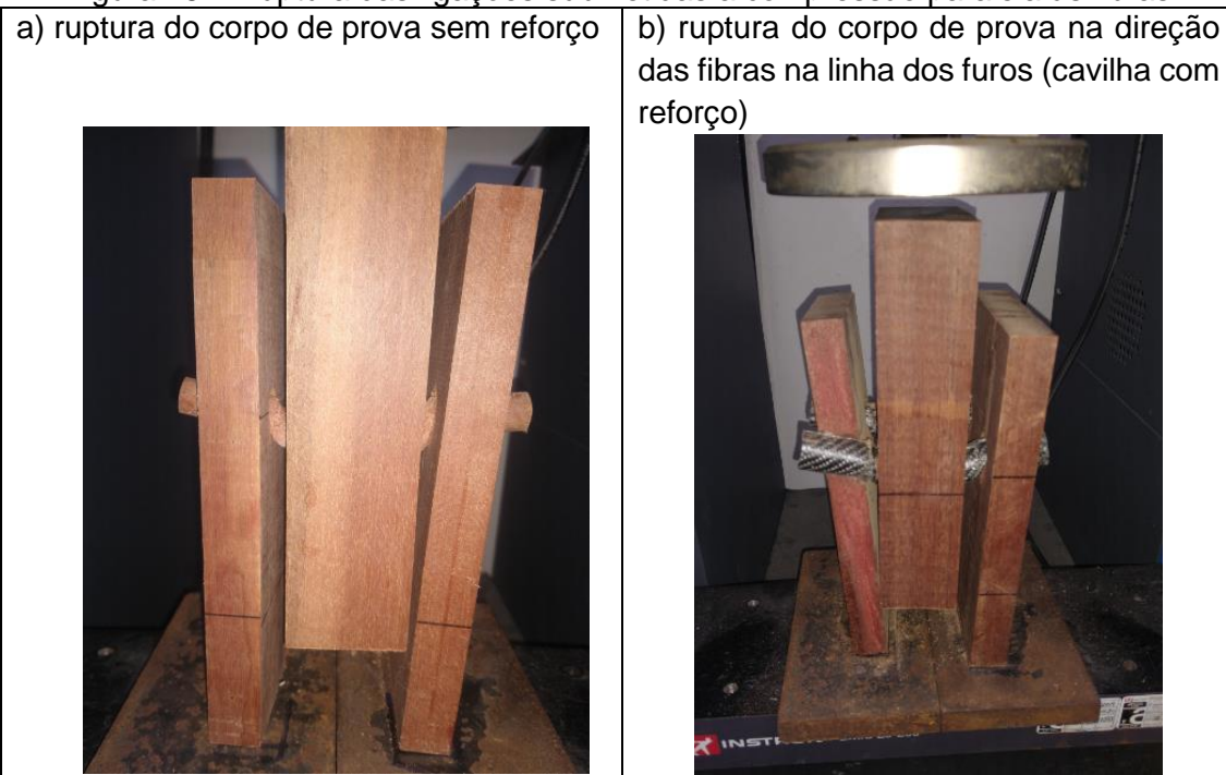
Figura 46 – Ruptura das ligações submetidas a compressão paralela às fibras
