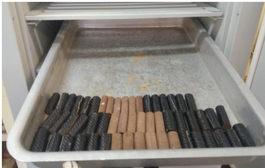
Figura 24 – Cavilhas na estufa para avaliação da estabilidade dimensional
