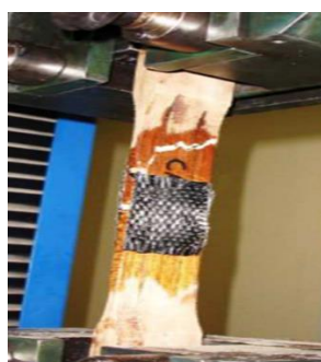
Figura 9 – Corpos de prova reforçados com PRF.
