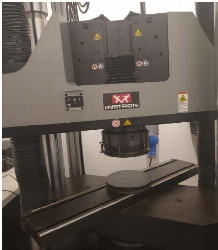
a) máquina universal Instron 1000HDX
