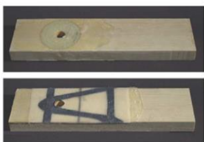
Figura 9 – Corpos de prova reforçados com PRF.
