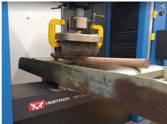
Figura 35 – Execução do ensaio de flexão da cavilha sem reforço
