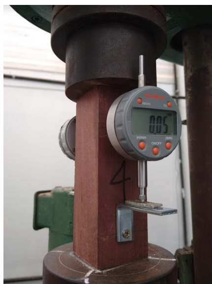
Figura 28 – Detalhe dos corpos de prova de ensaio de compressão paralela às fibras a) dimensões do corpo de prova b) execução do ensaio
