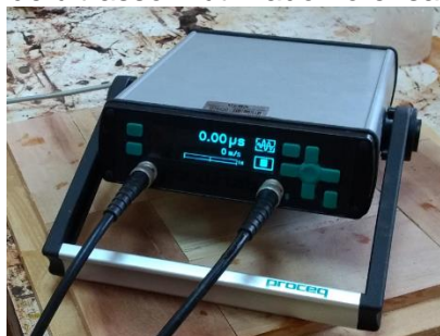
Figura 32 – Aparelho de ultrassom utilizado no ensaio não destrutivo
