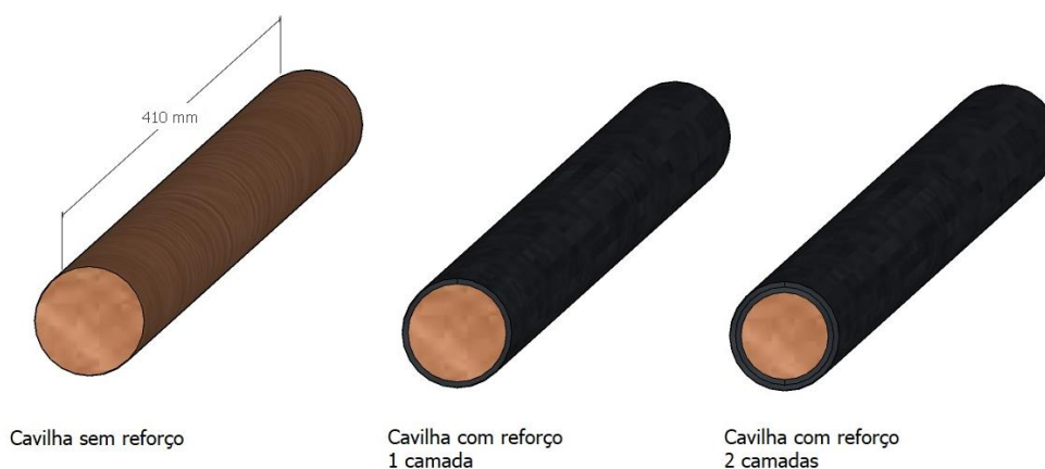
Figura 34 – Detalhe dos corpos de prova do ensaio de flexão nas cavilhas
