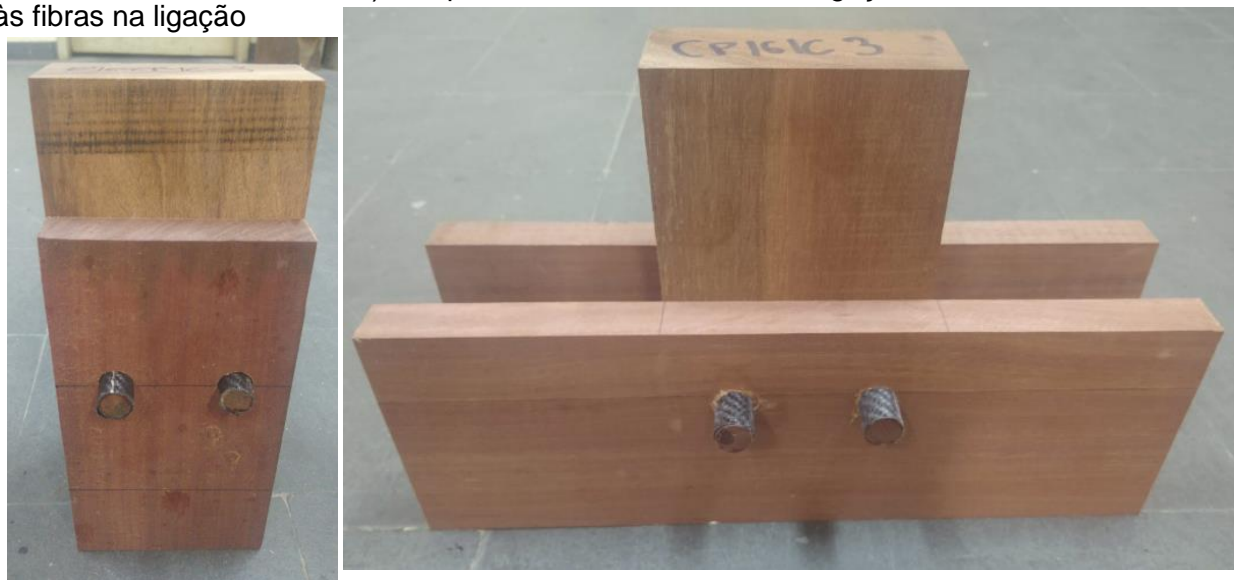
Figura 36 – Dimensões dos corpos de prova do para os ensaios na ligação
