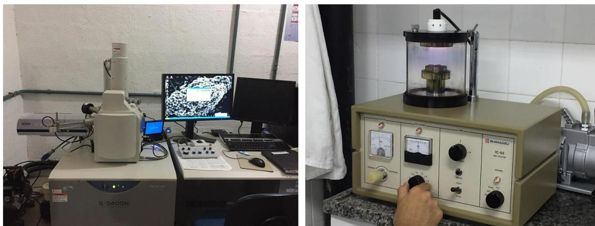
(a) Microscópio eletrônico de varredura
