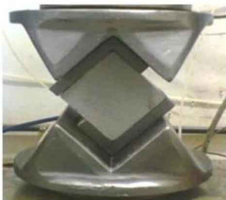
(a) Vista do corpo de prova, ajustado no dispositivo em formato de L.
