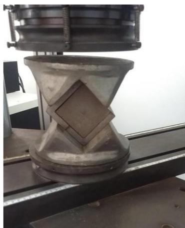
(a) Corpo de prova, ajustados no dispositivo em formato de L, acoplados na base metálica, para a submissão do carregamento
