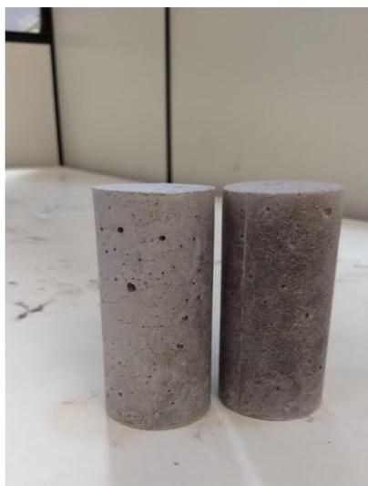
(a) Amostra de CA, após ser submetido a uma temperatura de até 700 °C.
