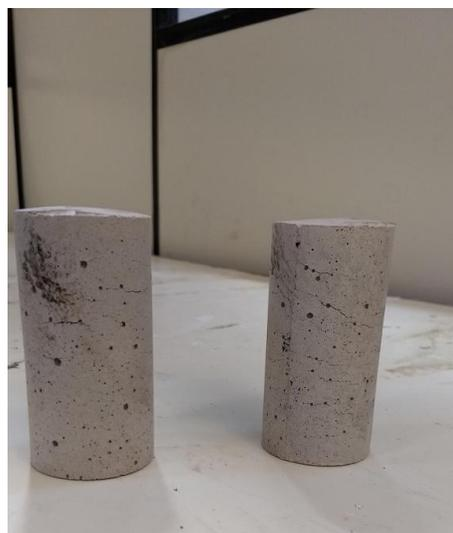
(b) Amostra de CE, após ser submetido a uma temperatura de até 700 °C.
