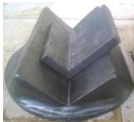
(b) Vista das peças no dispositivo em formato de L, acoplado na base metálica.
