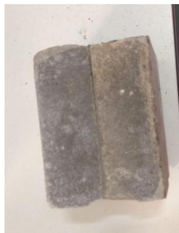
(b) Ruptura de cisalhamento do corpo de prova, após o carregamento.
