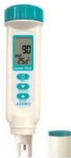
Figura 44. Condutivímetro de bolso utilizado na determinação das condutividades elétricas (CE).
