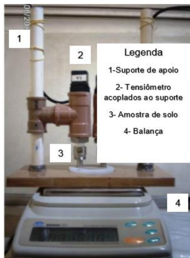
Figura 51. Sistema utilizando tensiômetros de baixa capacidade neste trabalho.
