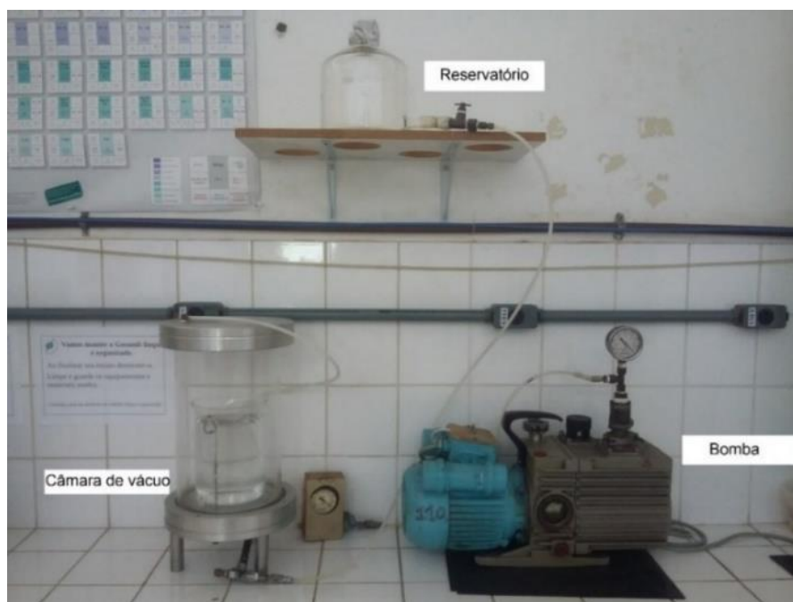
Figura 47. Sistema de desaeração das capas deste trabalho.
