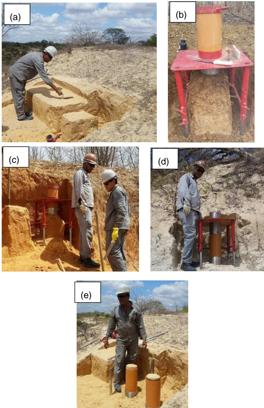
Figura 30. Coleta de amostras indeformadas no RN e CE: (a) limpeza e regularização; (b) montagem da mesa e acessórios; (c) execução da cravação e coleta; (d) colocação do extensor; (e) finalização da coleta.
