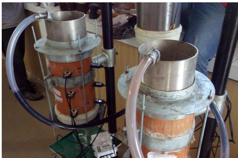
Figura 64. Ensaios de coluna com percolação de óleo bruto (O).
