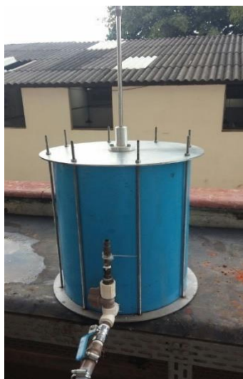
Figura 63. Mariotte de água deionizada.
