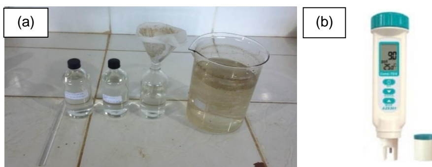
Figura 66. Diluição de fluidos (AP e ET): (a) vidrarias utilizadas; (b) condutivímetro de bolso.
