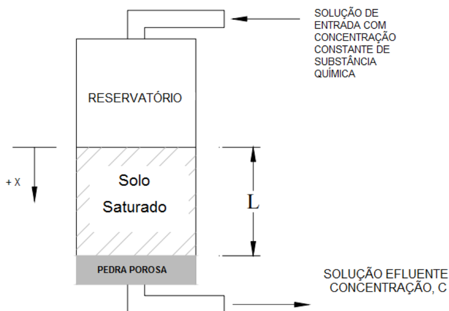
Figura 16. Ensaio de coluna com concentração constante na fonte e solo saturado (ADAPTADO SHACKELFORD, 1991).
