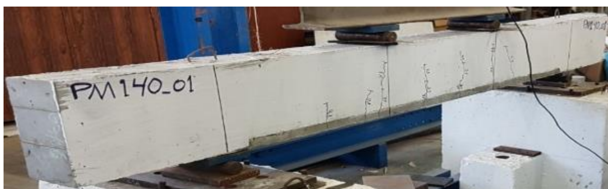
Vigas de reparadas com argamassa comercial e extensão de 140 cm (RB.PM140).
