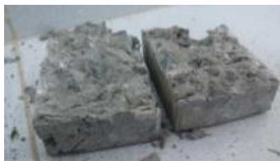
(c) Corpo de Prova fraturado
