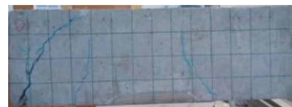
Vigas com reparo trapezoidal, espessura 2,5 cm e extensão 21 cm.
