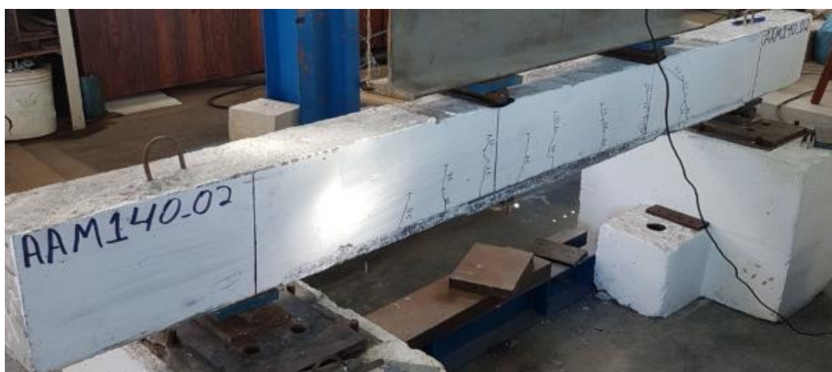
Vigas de reparadas com argamassa comercial e extensão de 50 cm (RB.PM50).
