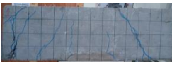
Vigas com reparo trapezoidal, espessura 2,5 cm e extensão 21 cm.
