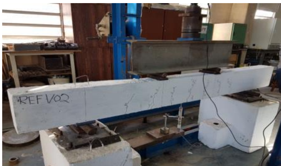
Figura 5.44. Ensaio de tração na flexão de vigas 210.
