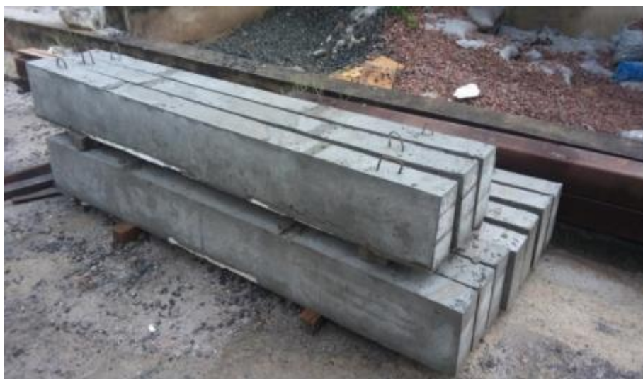
Figura 5.40. Armazenamento e cura das vigas.
