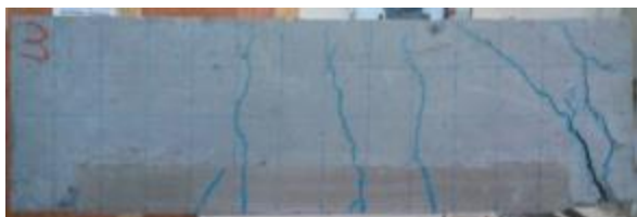
Vigas com reparo trapezoidal, espessura 2,5 cm e extensão 15 cm.
