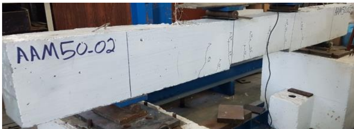
Vigas de reparadas com argamassa álcali ativada e extensão de 140 cm (RB.AAM140).
