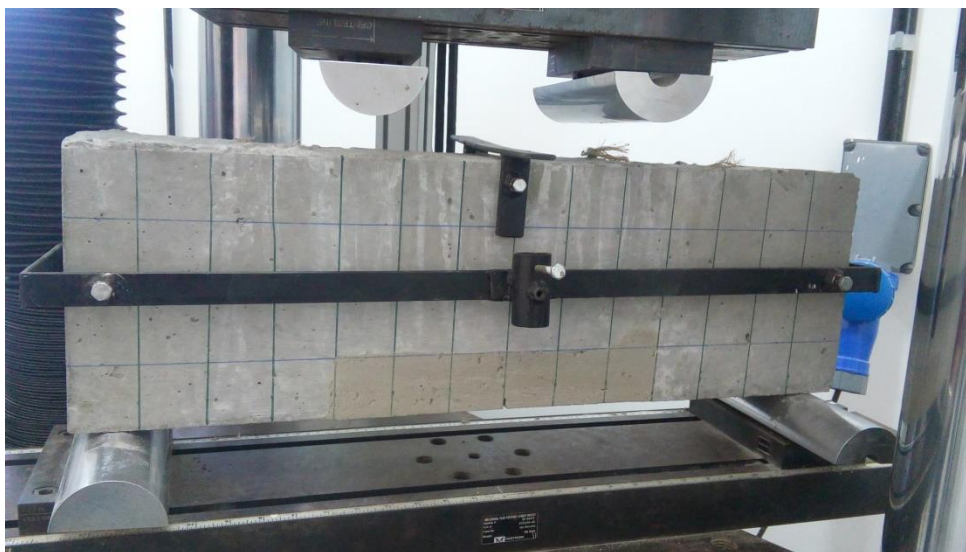
Figura 5.26. Esquema de ensaio de tração na flexão.
