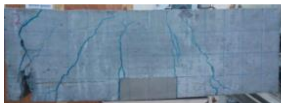
Vigas com reparo retangular, espessura 5,0 cm e extensão 15 cm.
