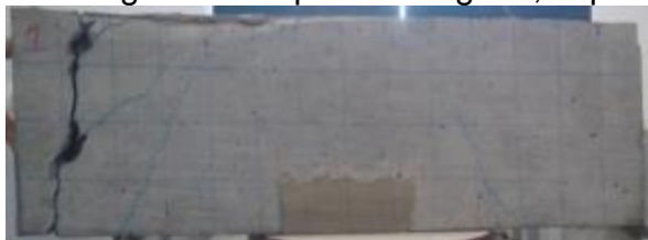
Vigas com reparo retangular, espessura 5,0 cm e extensão 15 cm.
