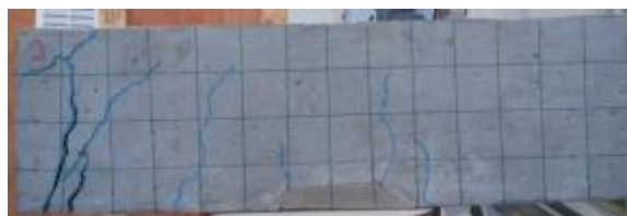
Vigas com reparo trapezoidal, espessura 2,5 cm e extensão 15 cm.
