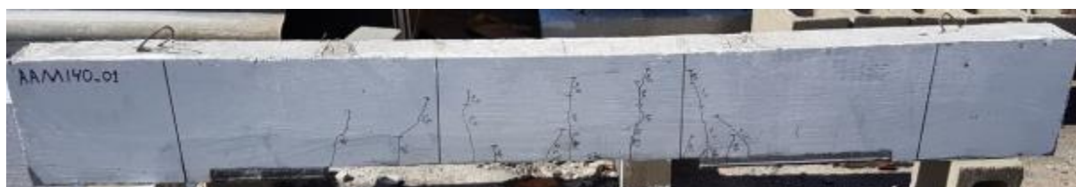
Vigas de reparadas com argamassa álcali ativada e extensão de 140 cm (RB.AAM140).
