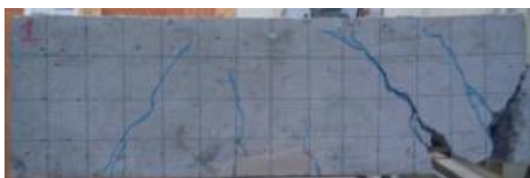
Vigas com reparo trapezoidal, espessura 2,5 cm e extensão 15 cm.
