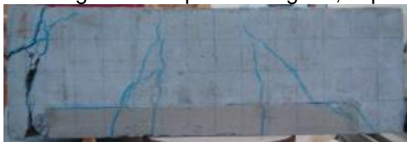
Vigas com reparo retangular, espessura 5,0 cm e extensão 56 cm.
