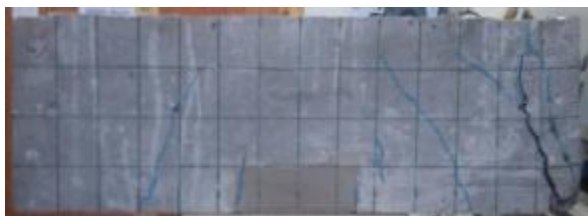
Vigas com reparo retangular, espessura 5,0 cm e extensão 21 cm.
