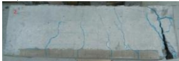
Vigas com reparo retangular, espessura 2,5 cm e extensão 56 cm.
