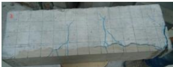
Vigas com reparo retangular, espessura 5,0 cm e extensão 15 cm.
