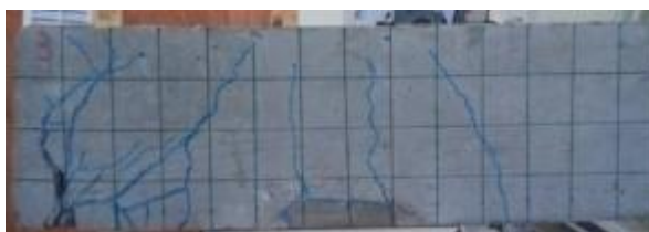
Vigas com reparo trapezoidal, espessura 2,5 cm e extensão 21 cm.
