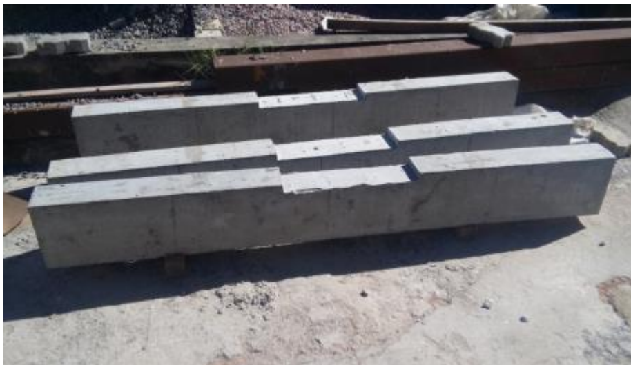
(a) Extensão do reparo de 50 cm.
