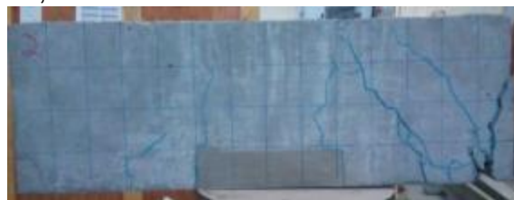
Vigas com reparo retangular, espessura 5,0 cm e extensão 21 cm.
