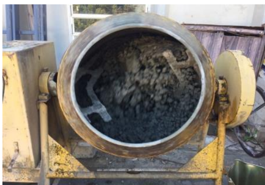
Figura 5.11. Betoneira eixo inclinado 220 litros.
