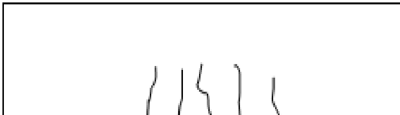
Figura 2.6. Fissura por flexão
