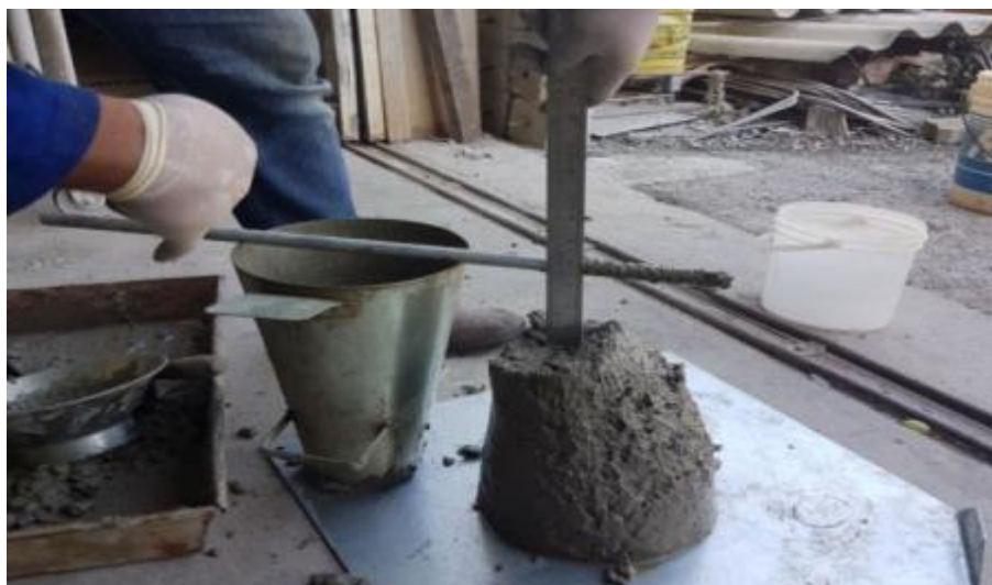
Figura 5.12. Ensaio slump Test.
