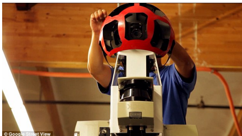
Imagem 9: Instalação de câmera com 15 lentes
