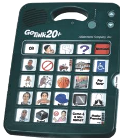
Figura 14 –Vocalizador GoTalk ( é um gravador de voz e necessita acesso direto em suas teclas). (CLIK, 2009)
