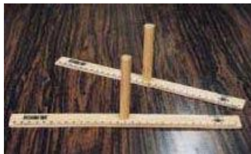
Figura 5 - Régua adaptada para facilitar a pressão e mantê-la estável. (GALVÃO FILHO, 2009, p.162)
