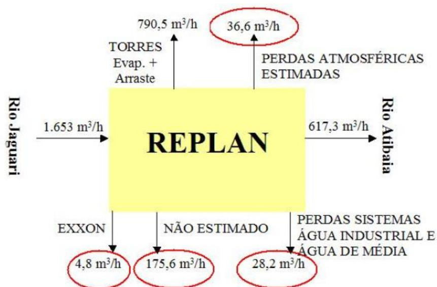
Figura 58: Balanço hídrico total da REPLAN considerando somente as entradas e saídas globais da Refinaria REPLAN
