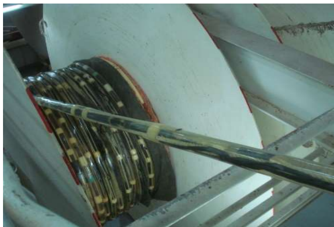
Figura 11 – Carretel com o cabo sísmico ( streamer ) que será rebocado na água.
