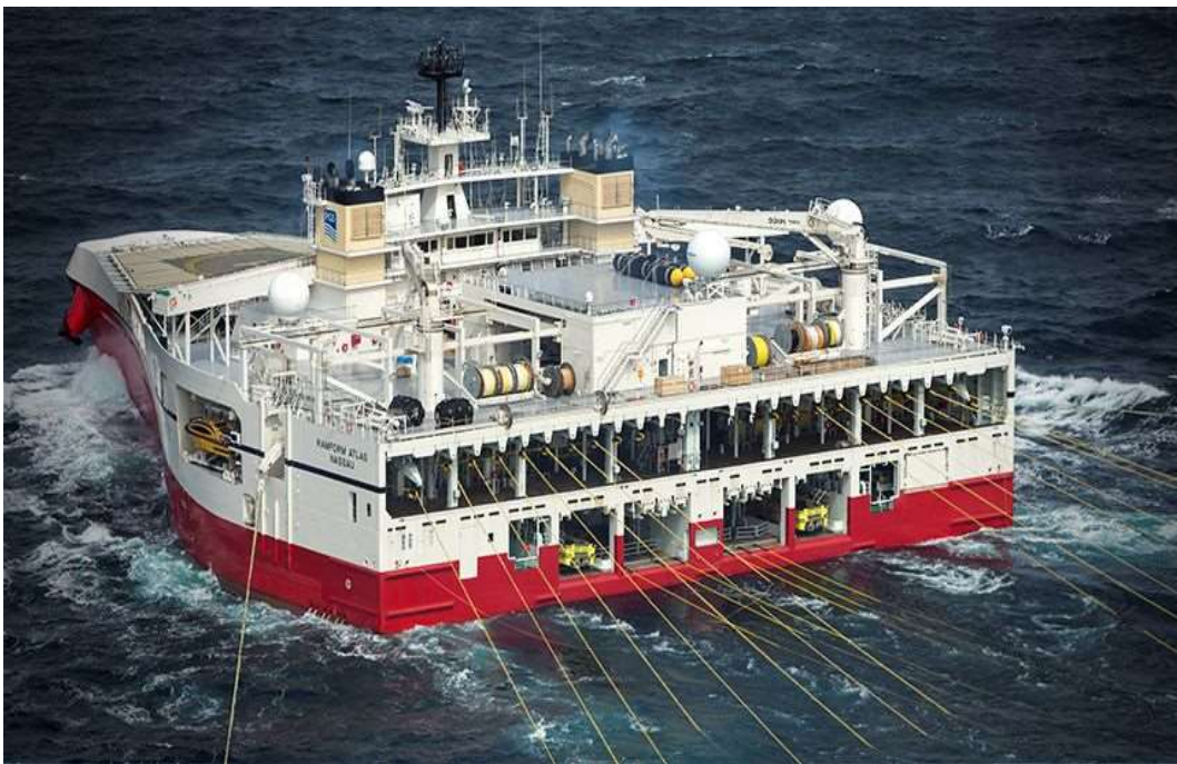
Figura 15 – Imagem da Embarcação Principal rebocando fontes e cabos - PGS Ramform Sovering .
