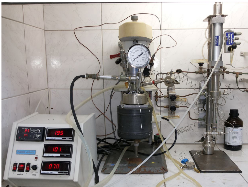
Figura 1. Sistema reacional para produção de polietileno e nanocompósitos.
