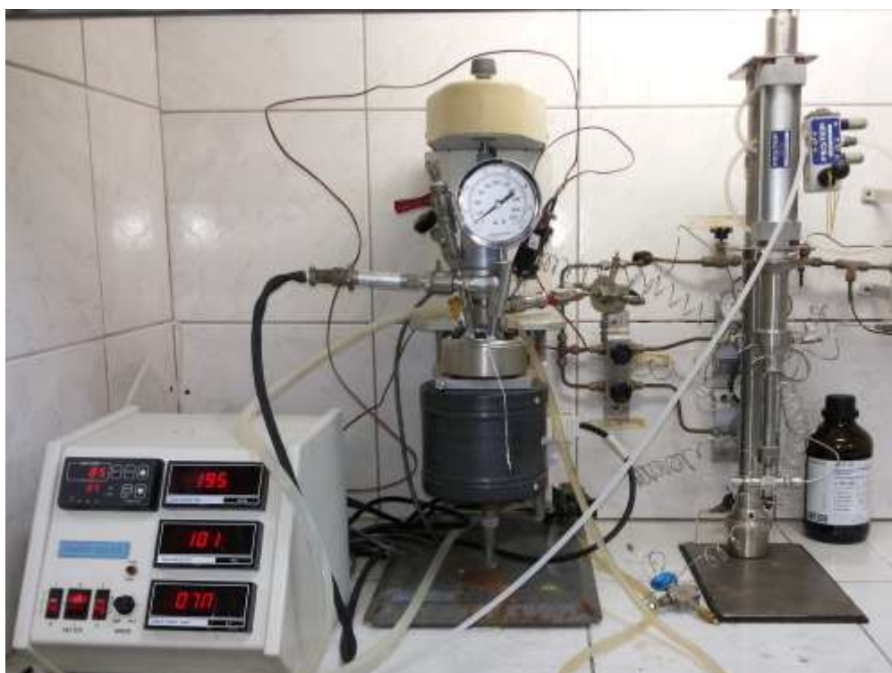
Figura 4.1 - Sistema reacional para produção de polietileno e nanocompósitos.
