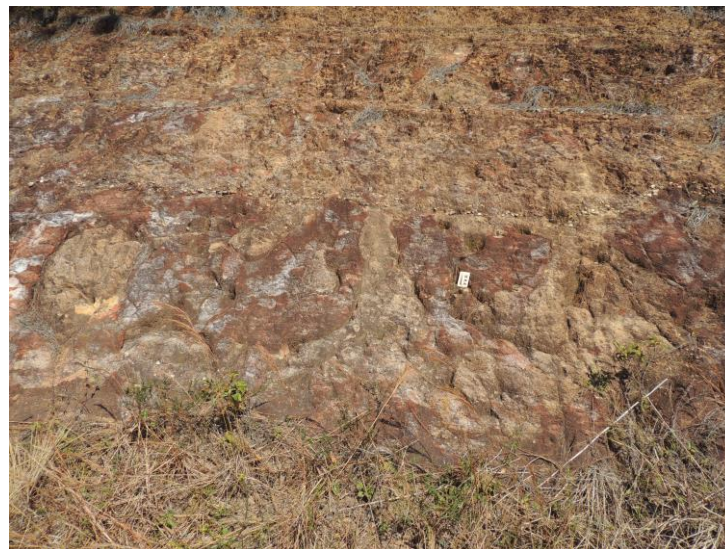
Figura 14- Camadas misturadas em afloramento da Formação Barreiras. A camada mais escura, evidenciando menor saturação em água e é envolvida pela camada mais clara, que apresenta comportamento mais dúctil.
