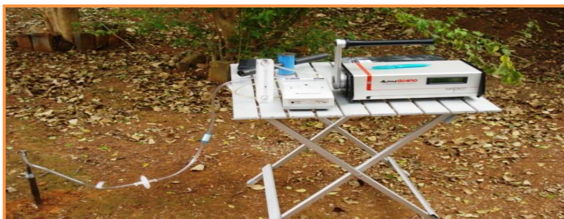
Figura 4.3. O Alphaguard PQ-200 medindo radônio no solo de uma residência no bairro do Stiep, Salvador, Ba (2012)
