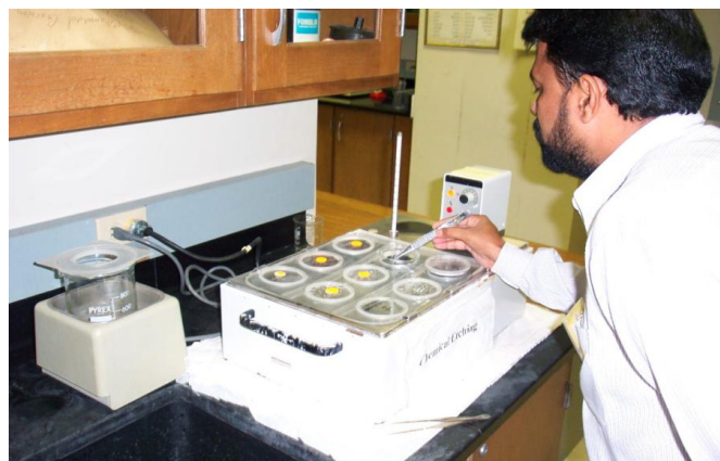
Figura 5.6 Uma vista breve do processo laboratorial de revelação química dos SSNTD
